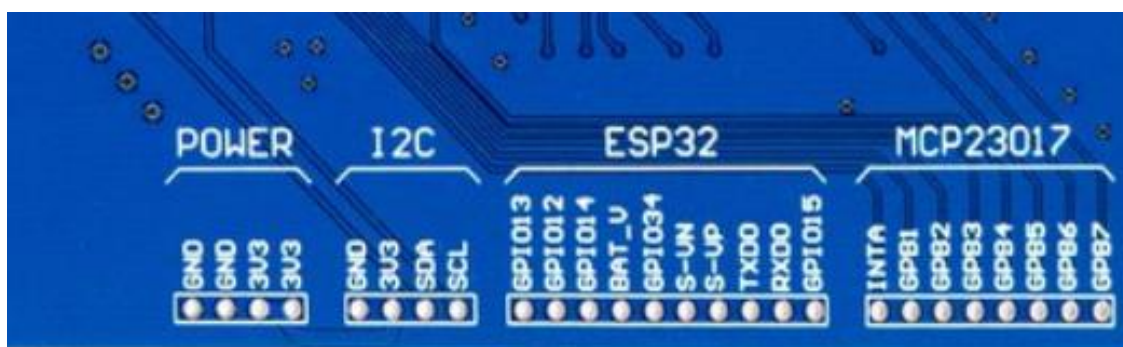
Sl. 3.1 Inkplate 6 izvedene nožice mikrokontrolera
