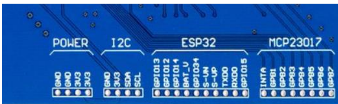
Sl. 3.1 Inkplate 6 izvedene nožice mikrokontrolera
