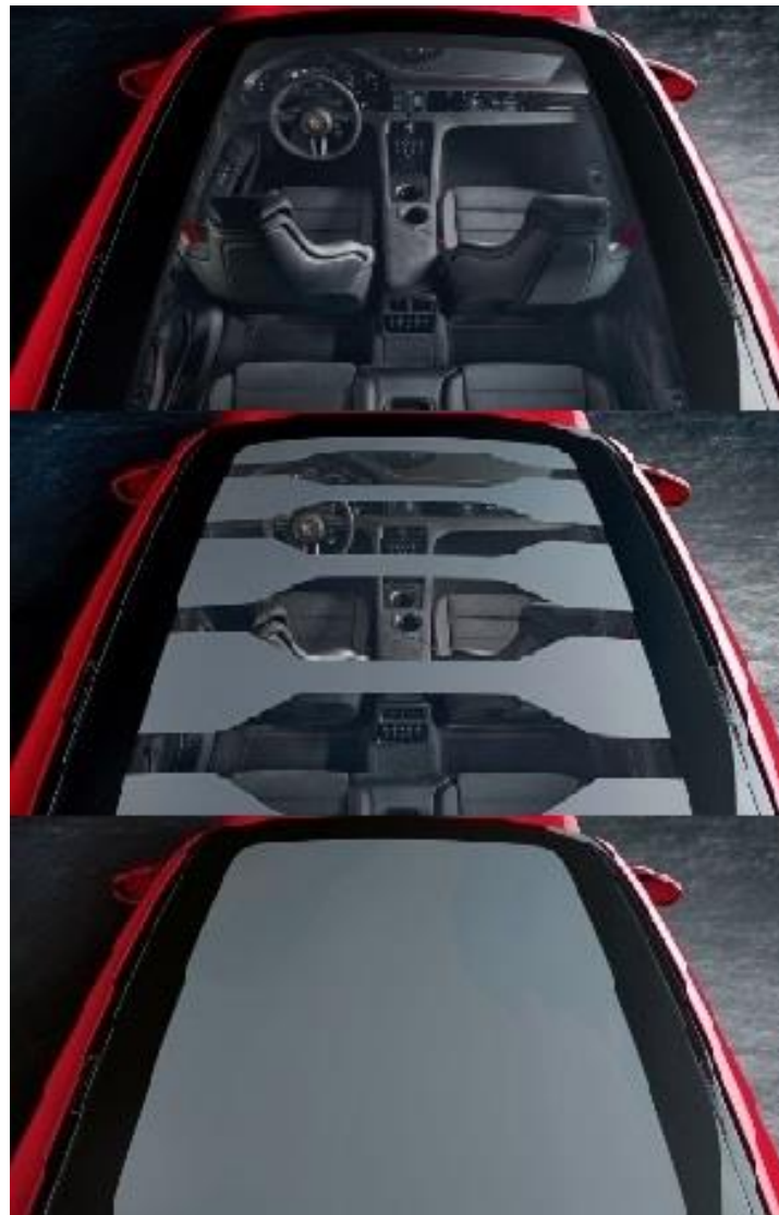
SI 2.18 Elektrokromatski krovni prozor Porsche Taycana [18]
