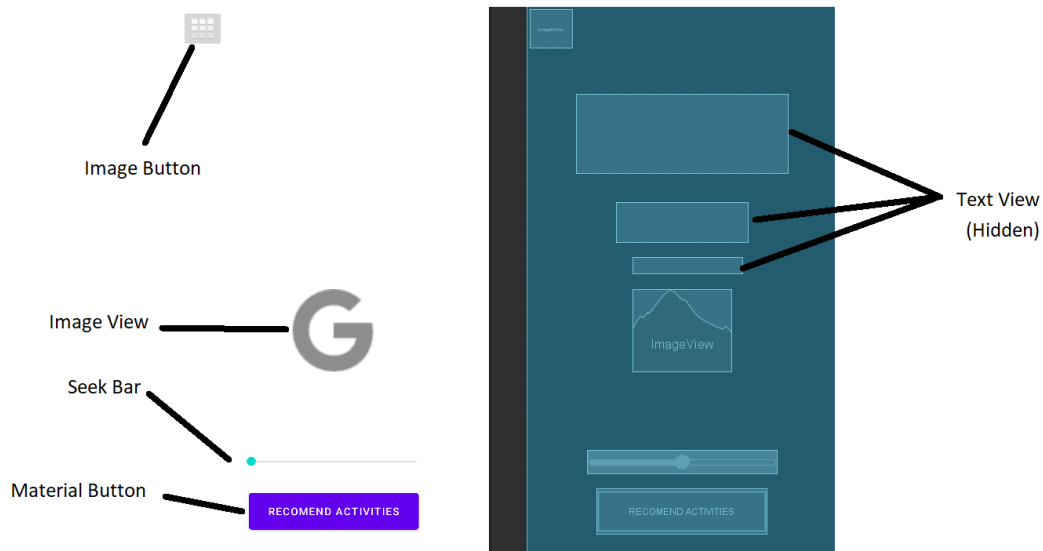
Slika 4.6. Prikaz XML rasporeda aktivnosti MainActivity
