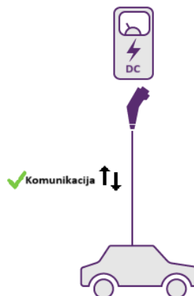
Slika 4.11. Način 4 - punjenje pomoću javne punionice, istosmjerna struja [38]
