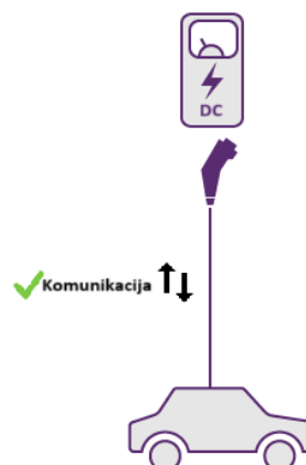
Slika 4.11. Način 4 - punjenje pomoću javne punionice, istosmjerna struja [38]
