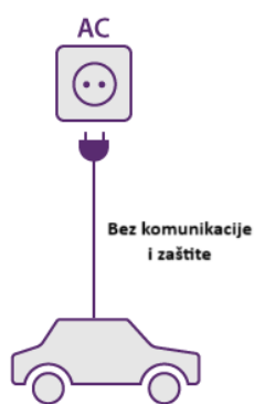
Slika 4.8. Način 1 - punjenje pomoću kućne utičnice bez zaštitnog uređaja [38]
