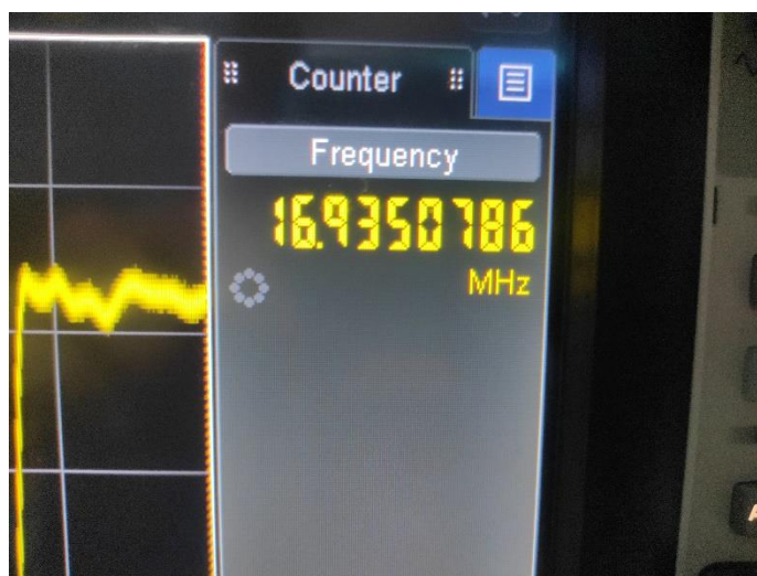
Slika 4.5. Frekvencija izlaznog signala oscilatora s kristalom koji radi u osnovnom načinu rada.
