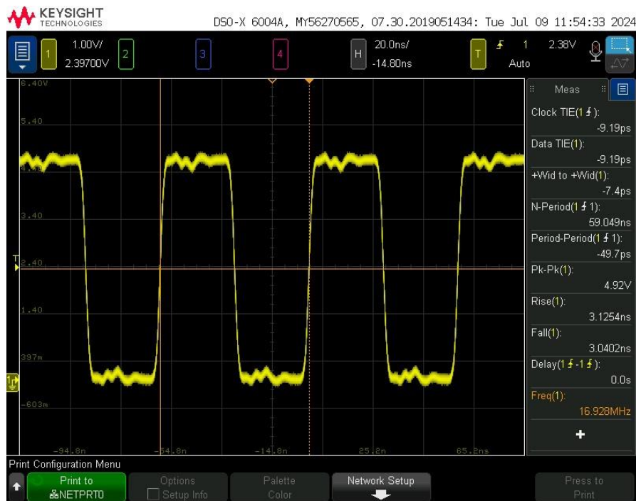
Slika 4.4. Valni oblik izlaznog signala oscilatora.
