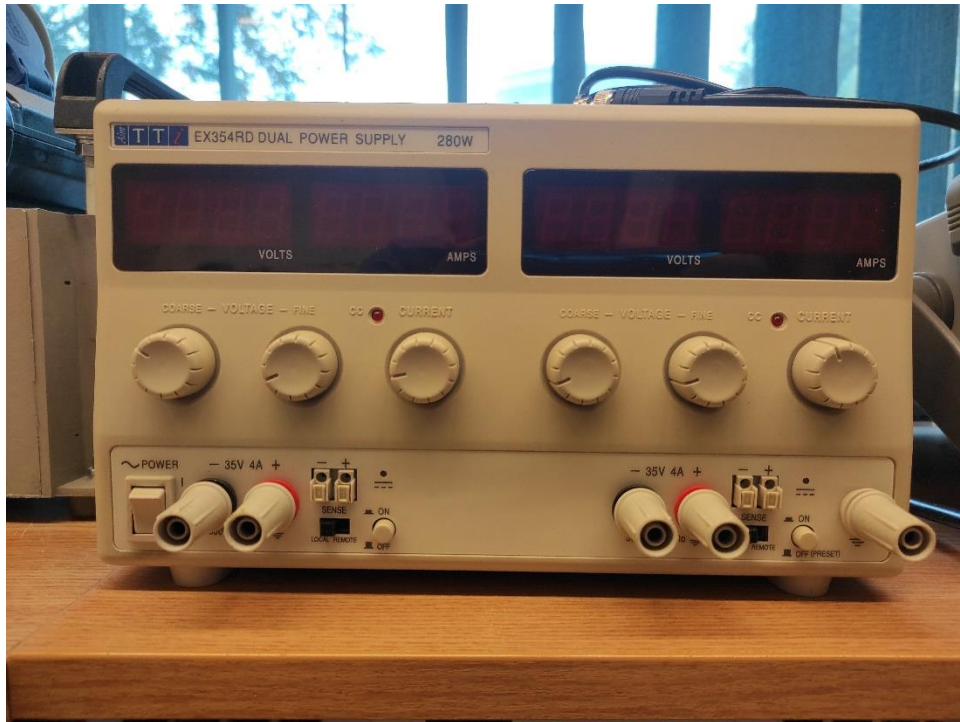
Slika 3.14. Laboratorijsko napajanje EX354RD.
