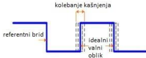
Slika 2.2. Prikaz kolebanja izlaznog signala oscilatora [2]
