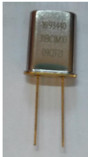
Slika 3.12. QT kvarcni oscilator za rad na trećem harmoniku.
