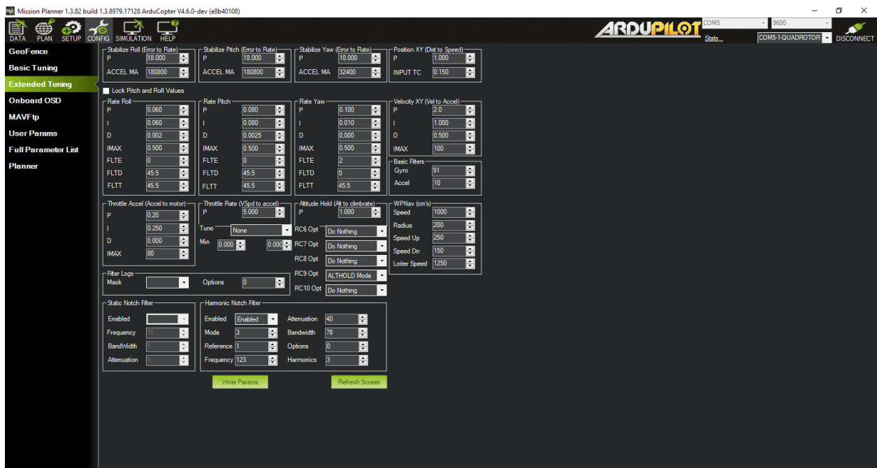
Slika 5.6. Prikaz parametara za PID regulator u Mission Planner-u
