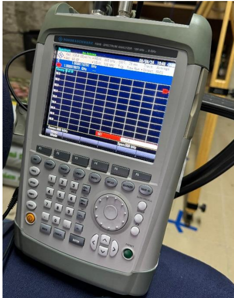
Slika 4.4 Spektralni analizator FSH8, R&S TS-EMF sustava
