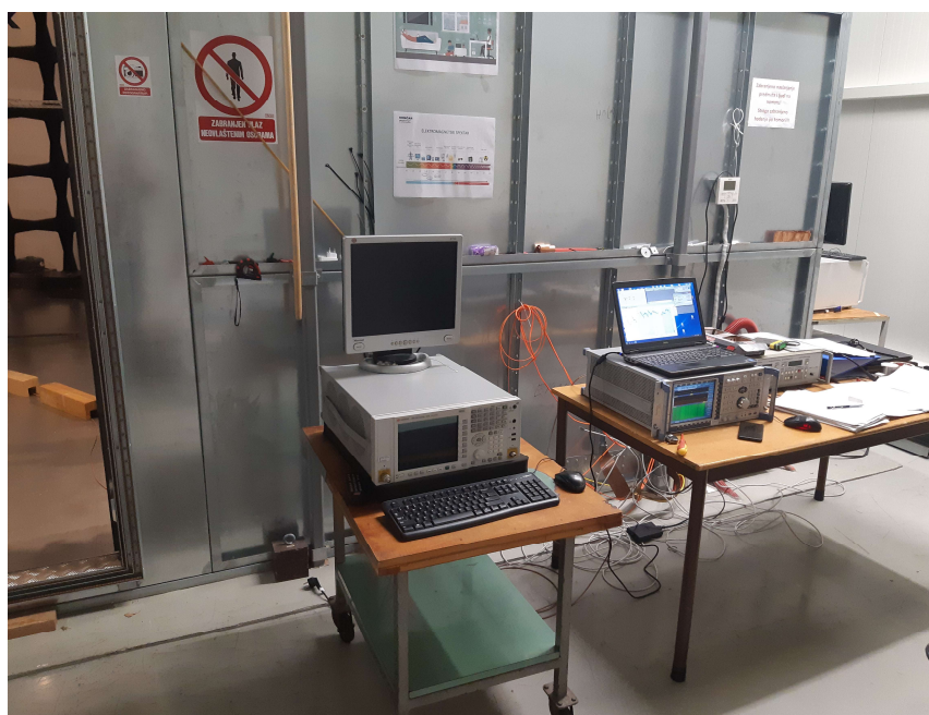
Slika 6.5. Prikaz mjernih uređaja za potrebe mjerenja jakosti izračenog električnog polja telekomunikacijskih kabela
