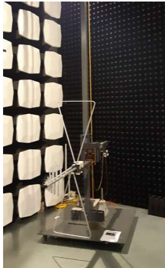
Slika 6.6. Prikaz položaja antene kod određivanja referentne razine izračenog električnog polja
