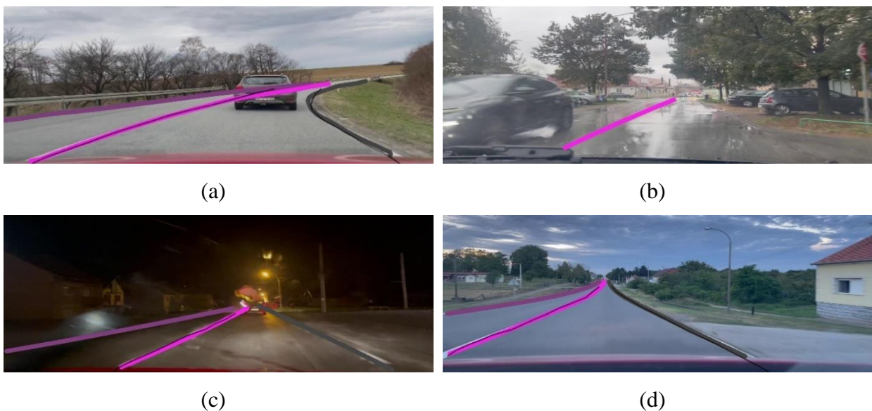
Slika 4.9 Prikaz predviđenih linija SCNN-VGG16 modela treniranog na CULane podatkovnom skupu i testiranog na novokreiranom skupu podataka (a) ruralno područje, krivina, djelomična naoblaka, auto zaklanja liniju (b) loša vidljivost, kišni dan, slaba vidljivost jedine linije (c) noćna vožnja po kiši, slaba vidljivost kroz vjetrobransko staklo, mutna slika (d) ravna cesta bez prometa, jako dobra vidljivost, sumrak
