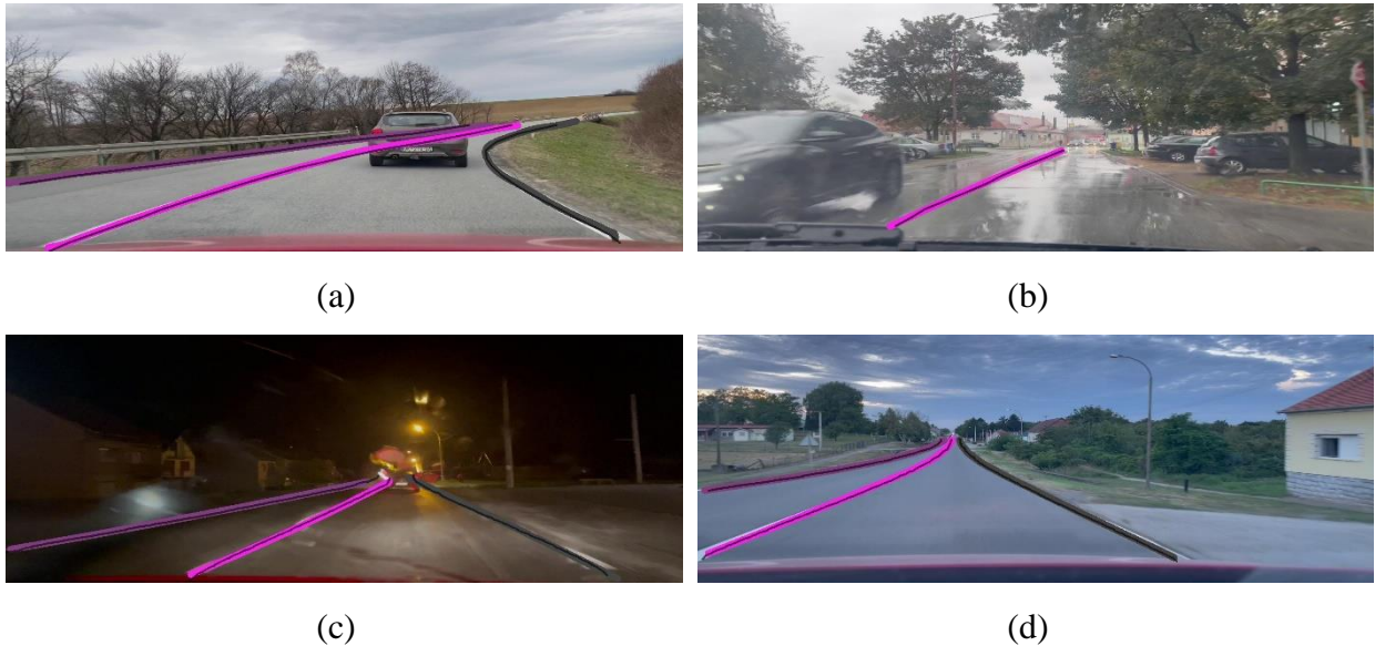
Slika 4.30 Prikaz predviđenih linija SCNN-VGG16 modela treniranog i testiranog na novokreiranom skupu podataka (a) ruralno područje, krivina, djelomična naoblaka, auto zaklanja liniju (b) loša vidljivost, kišni dan, slaba vidljivost jedine linije (c) noćna vožnja po kiši, slaba vidljivost kroz vjetrobransko staklo, mutna slika (d) ravna cesta bez prometa, jako dobra vidljivost, sumrak
