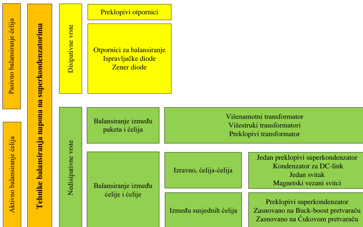
Slika 5.3. Tehnike ujednačivanja napona (balansiranja napona) na superkondenzatorima
