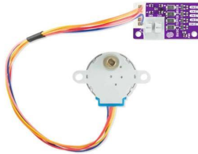
Slika 3.2. Stepper motor s driverom [6]
