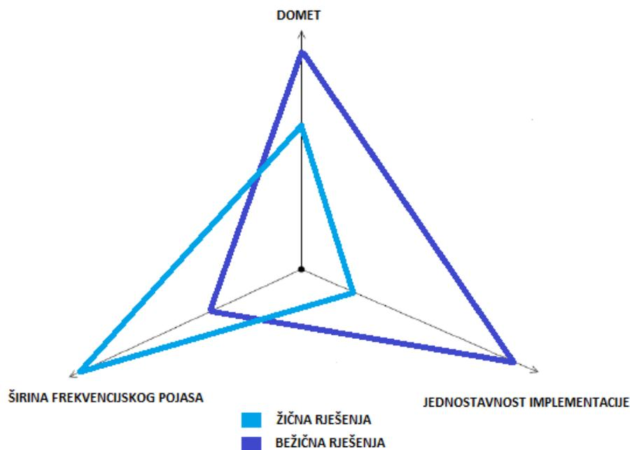
Slika 2.4. Usporedba žičnih i bežičnih pristupnih rješenja
