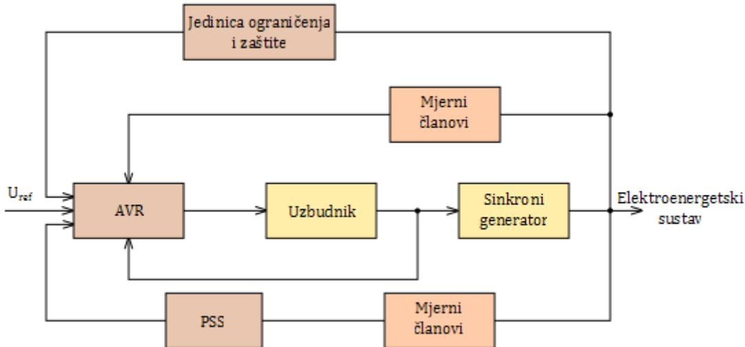
Slika 2. 1. Uzbudni regulacijski krug sinkronog generatora
