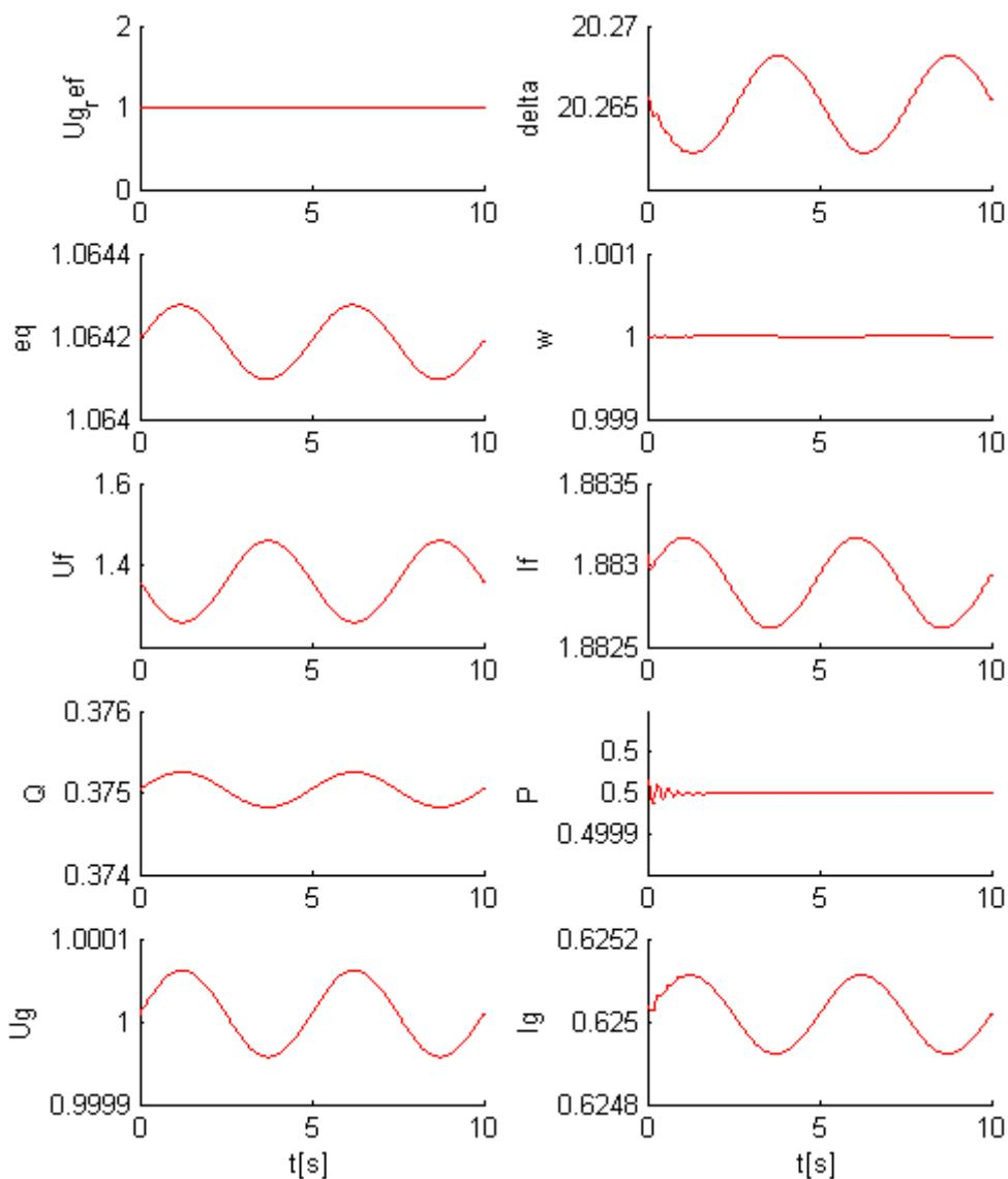
Slika 6.15. Odziv sustava na poremećaj uzbude frekvencije 0,2 Hz
