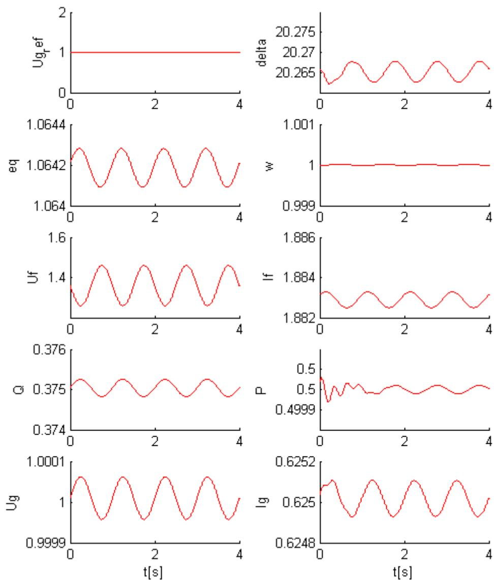
Slika 6.17. Odziv sustava na poremećaj uzbude frekvencije 1 Hz
