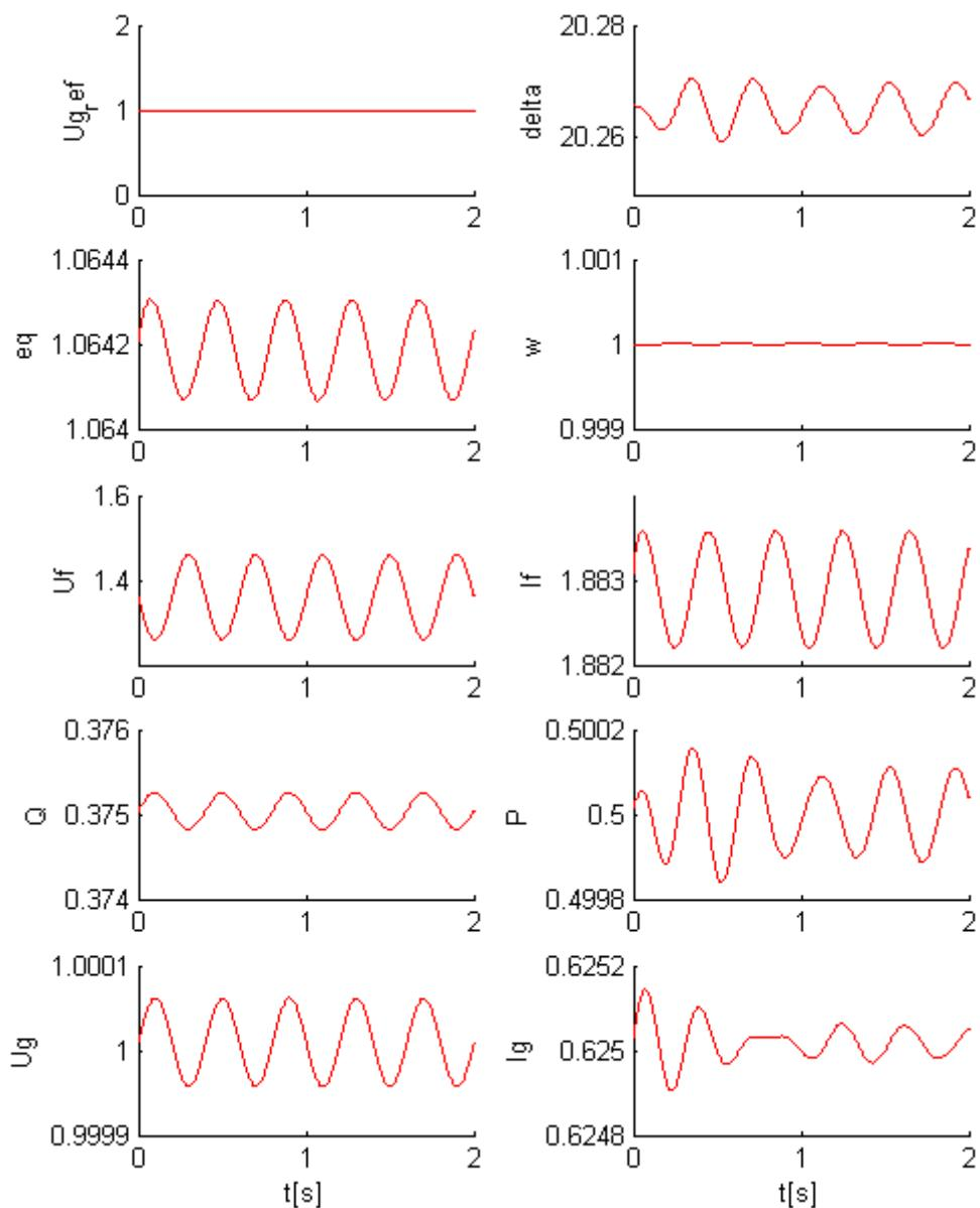
Slika 6.20. Odziv sustava na poremećaj uzbude frekvencije 2,5 Hz
