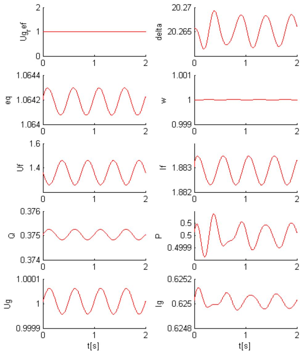
Slika 6.19. Odziv sustava na poremećaj uzbude frekvencije 2 Hz
