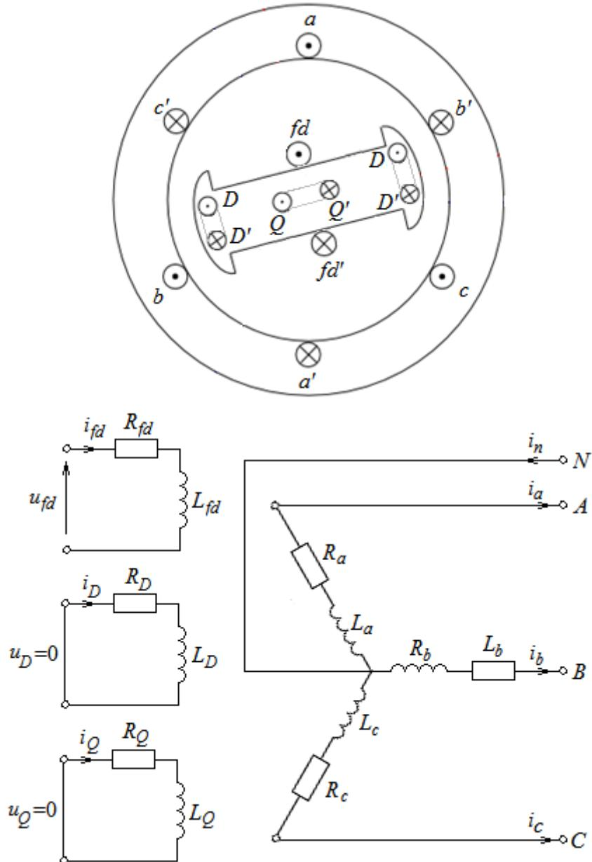
Slika 3.1. Konstrukcija i namoti modeliranog sinkronog generatora
