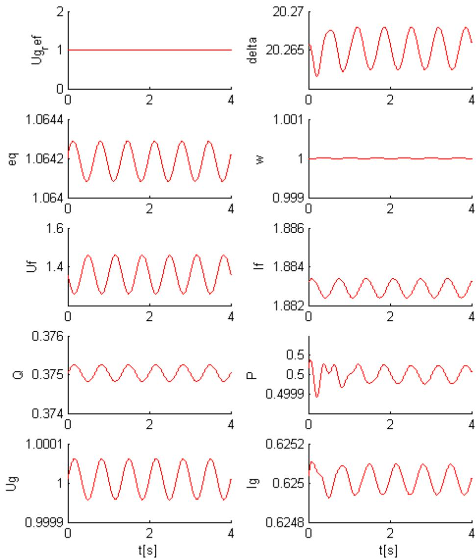
Slika 6.18. Odziv sustava na poremećaj uzbude frekvencije 1,5 Hz
