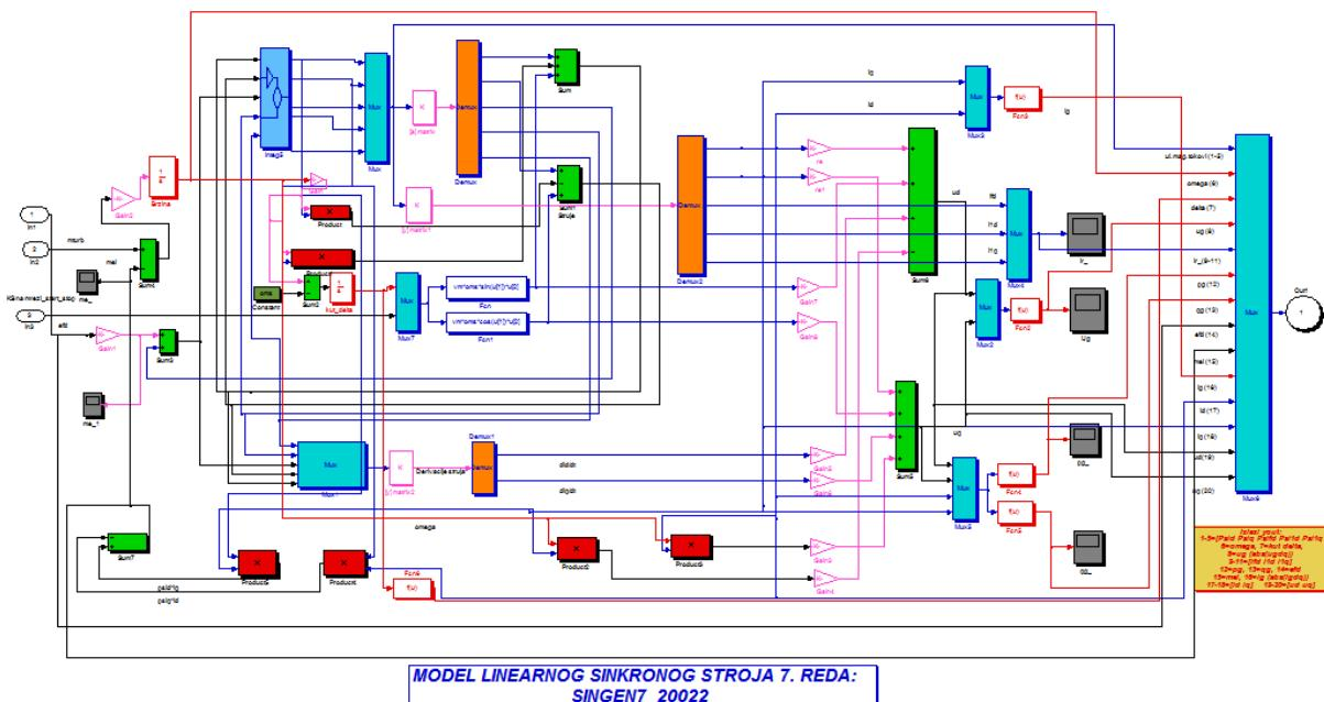
Slika 6.2. Model linearnog sinkronog stroja sedmog reda
