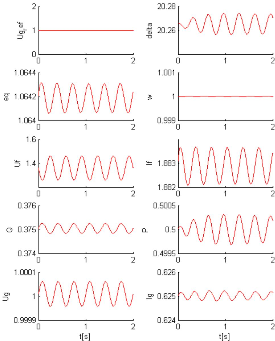
Slika 6.21. Odziv sustava na poremećaj uzbude frekvencije 3 Hz
