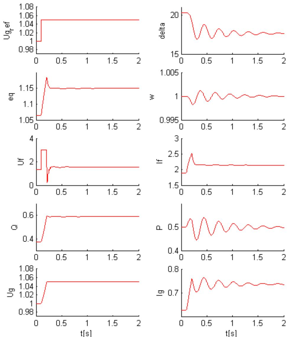
Slika 6.12. Povećanje referentnog napona generatora za 5%.
