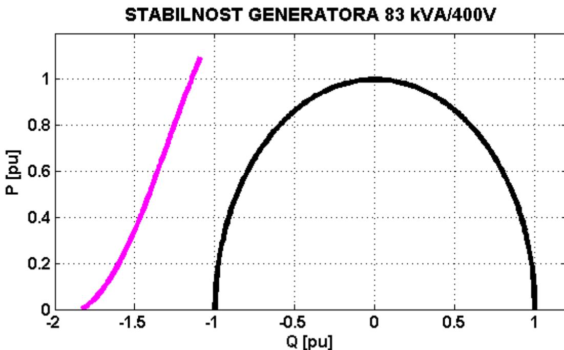
Slika 6.40. Pogonski dijagram i granica stabilnosti nereguliranog generatora
