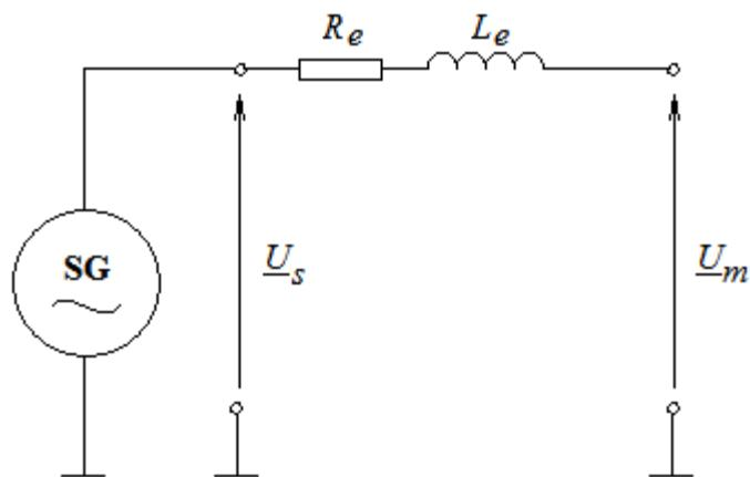
Slika 3.2. Sinkroni generator spojen u elektroenergetski sustav
