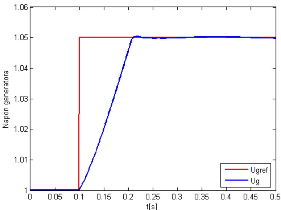
Slika 6.10. Odziv napona generatora na povećanje referentne vrijednosti
