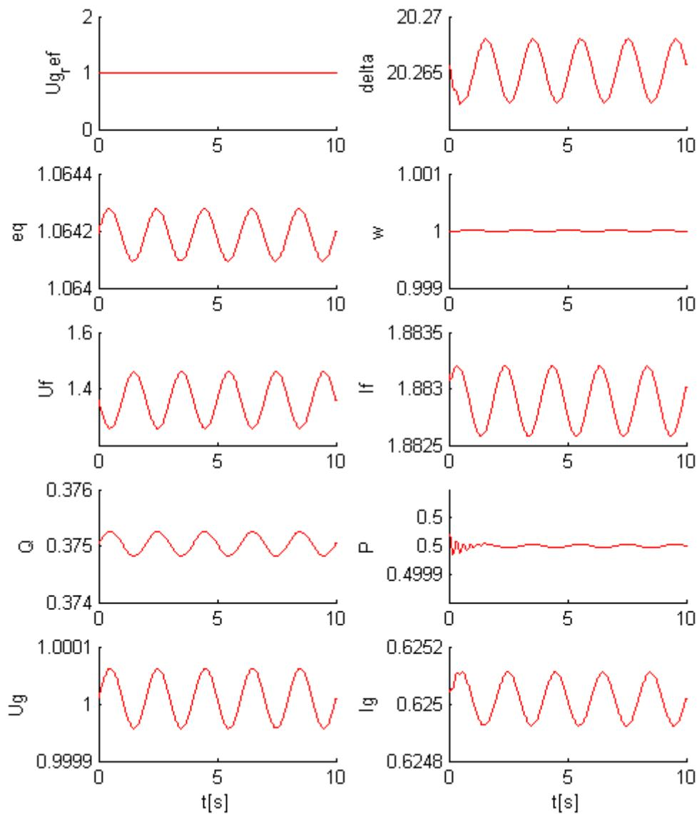
Slika 6.16. Odziv sustava na poremećaj uzbude frekvencije 0,5 Hz
