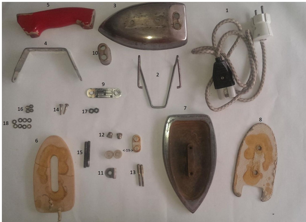
Slika 3.4. Prikaz rastavljenog glačala EG-450 (numerirano po tablici 3.2.)
