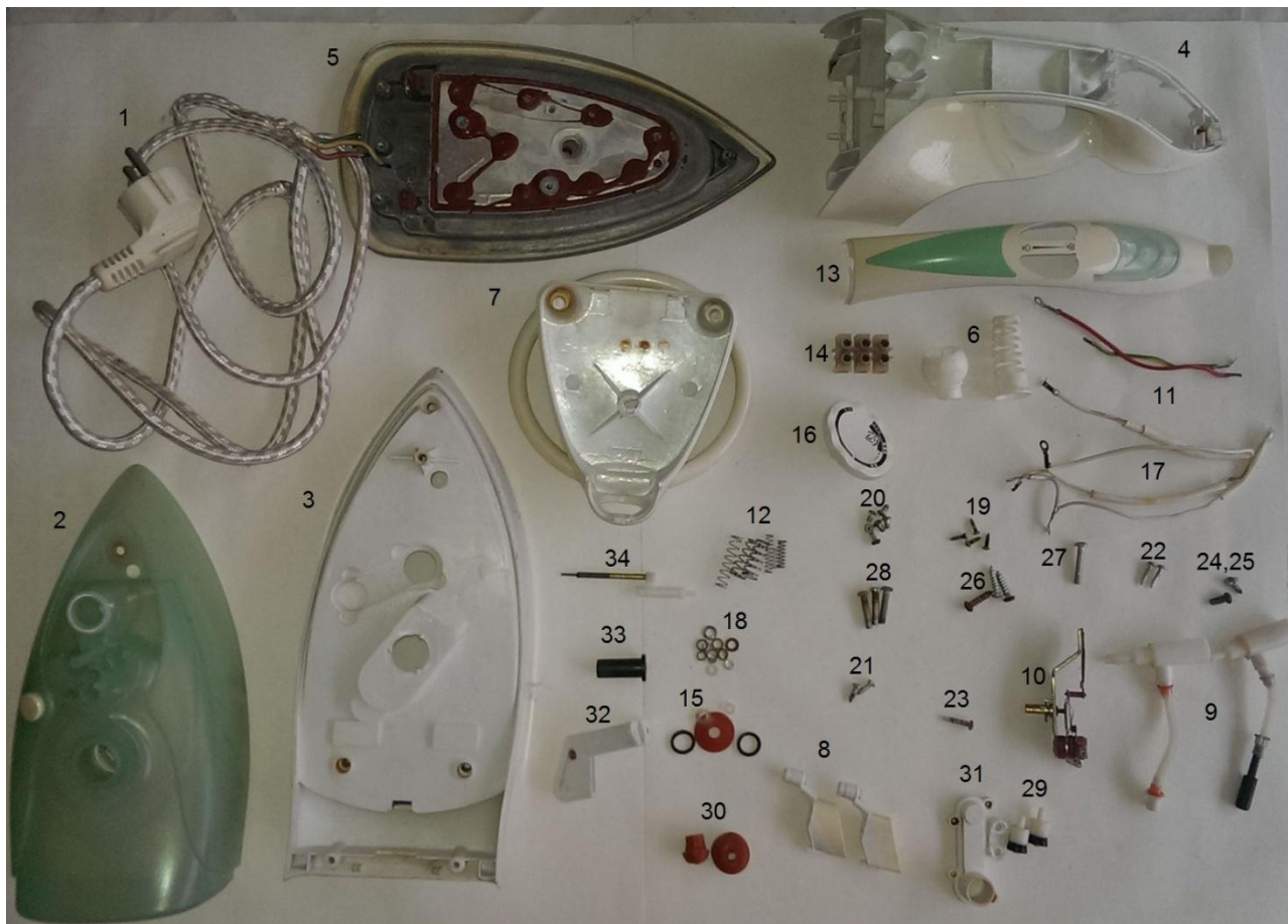
Slika 3.10. Prikaz rastavljenog multifunkcionalnog glačala HR-1600
