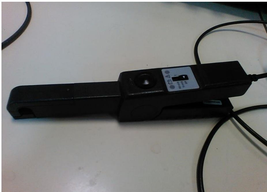
Slika 5.1.1. Strujna kliješta - Tektronix A622 AC/DC CURRENT PROBE
