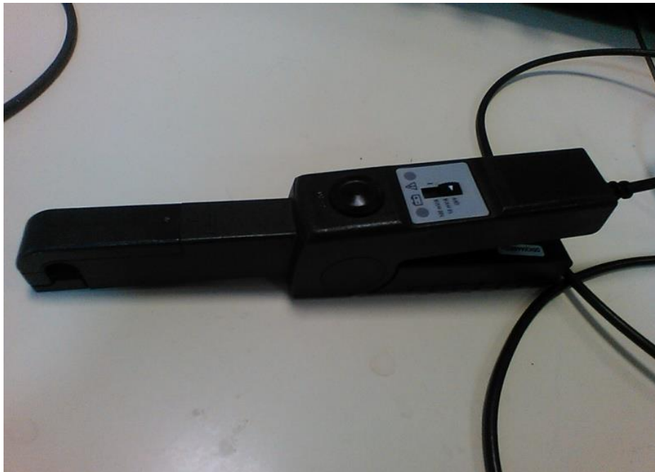
Slika 5.1.1. Strujna kliješta - Tektronix A622 AC/DC CURRENT PROBE
