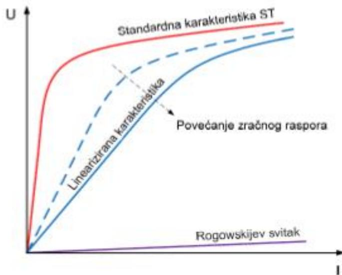
Slika 2.5. Naponsko-strujne karakteristike strujnog transformatora i Rogowskijevog svitka.[3]
