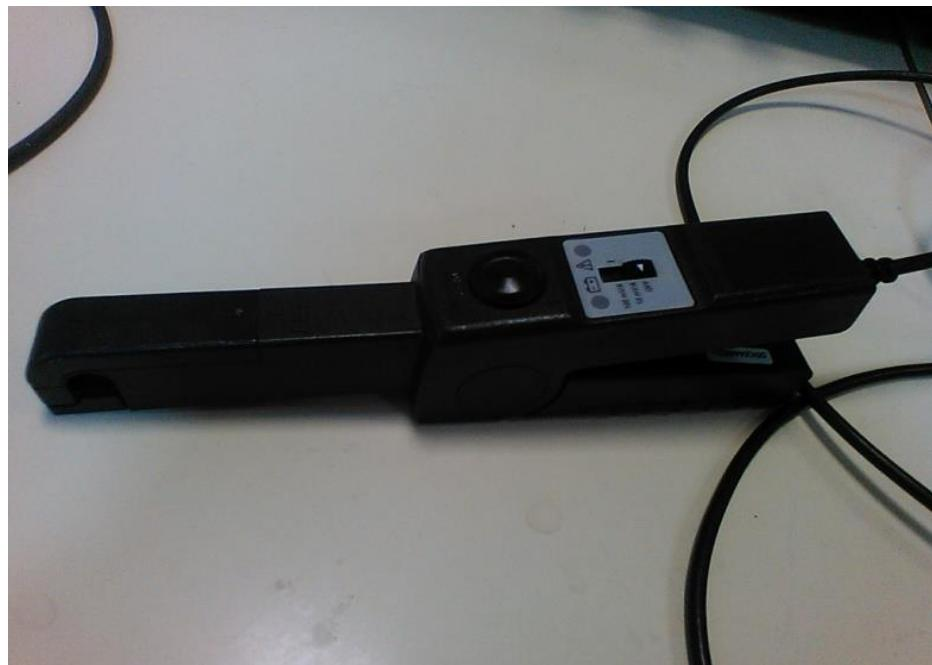
Slika 5.1.1. Strujna kliješta - Tektronix A622 AC/DC CURRENT PROBE
