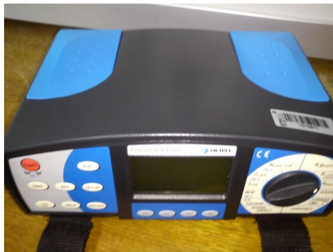
Sl. 5.5. Mjerni uređaj Metrel Eurotest 61557.
