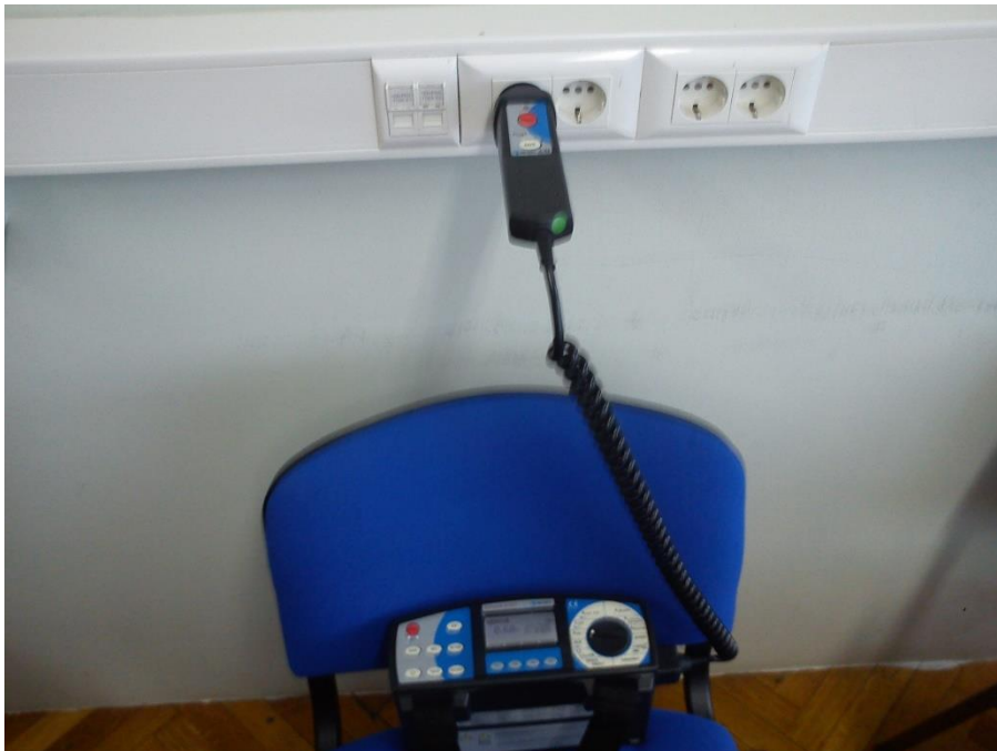
Sl. 5.12. Mjerenje impedancije na utičnici.
