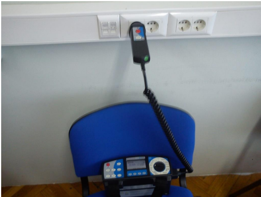
Sl. 5.12. Mjerenje impedancije na utičnici.
