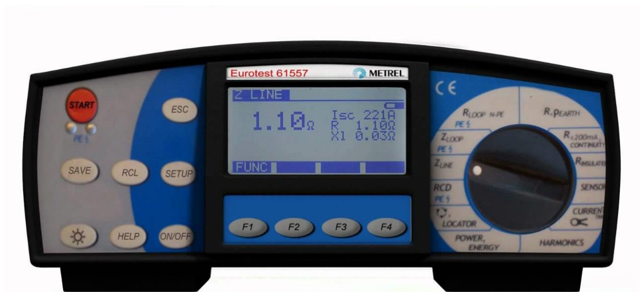
Sl. 5.2. Prikaz preklopke Metrela na položaj Z_{LINE} prilikom izvođenja mjerenja impedancije kratkospojne petlje.
