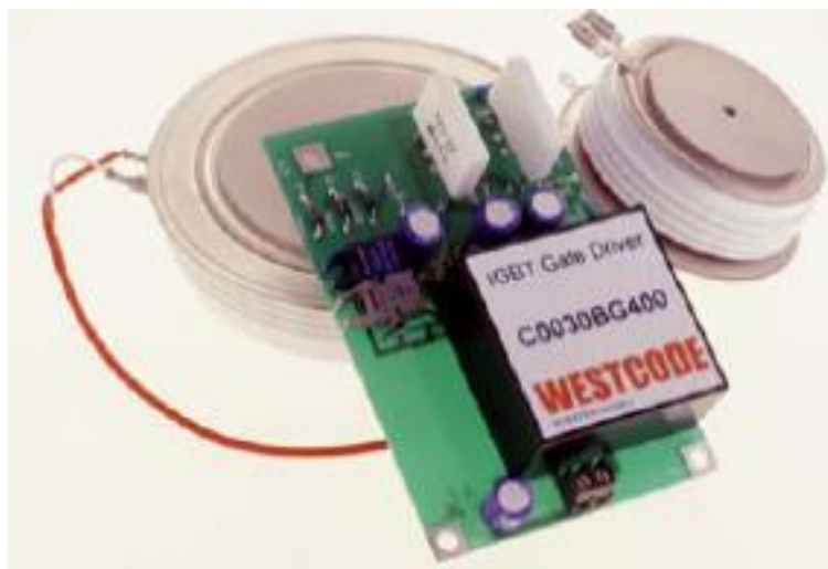
Slika 4.5. Suvremeni IGBT s kontrolnom jedinicom[11]
