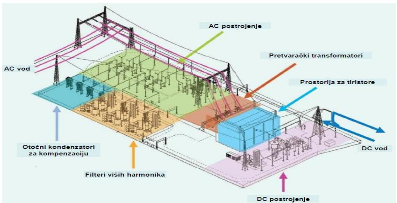
**Slika 3.1.** 3D prikaz pretvaračke stanice istosmjernog prijenosnog sustava[5]
