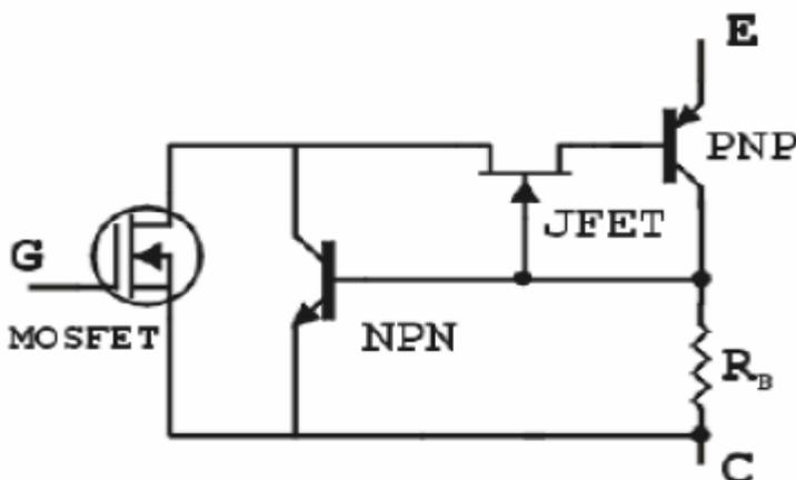
Na slici je prikazan pojednostavljeni prikaz IGBT tranzistora. NPN i PNP tranzistori predstavljaju paraziti TIRISTOR u kojem se pojavljuje regenerativni “latch-up” efekat, otpornik RB ima zadatak da smanji ovaj efekat, koje je kod IGBT tranzistora nepoželjan. JFET predstavlja (suženje) struje između dvije osnovne strukture (na ovaj način je MOSFET na niskom naponu te stoga ima nizak otpor Rds. Na slici(ispod) su prikazane karakteristike IGBT tranzistora.
