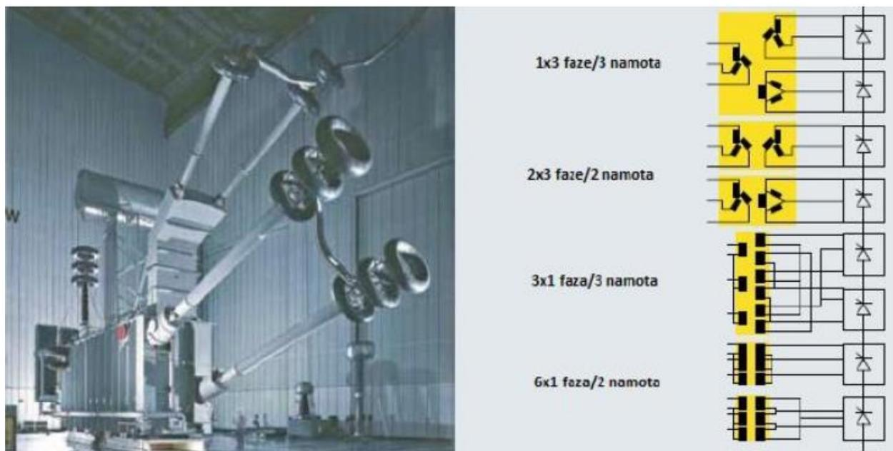
**Slika 3.7.** Pretvarački transformator i različiti razmještaji namota[3]
