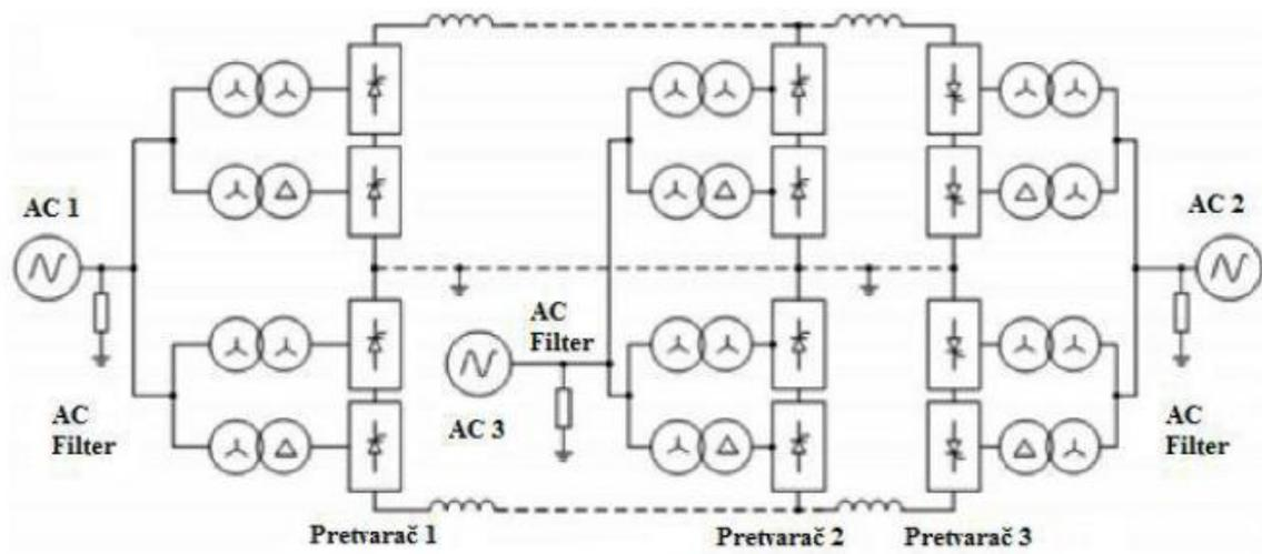
Slika 3.20. Višeterminalni način povezivanja visokonaponskog sustava[5]
