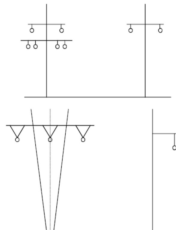
**Slika 2.2.** Konfiguracija stupova za izmjenični(lijevo) i za istosmjerni(desno) prijenos[1].
