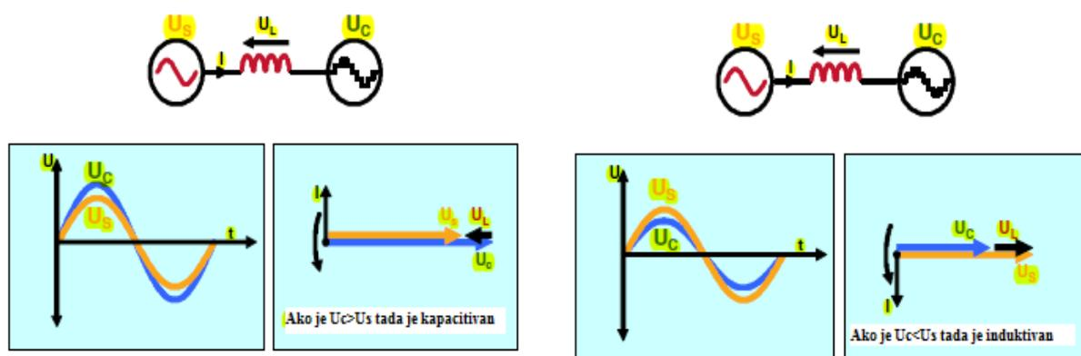
Slika 3.12. Princip rada STATCOM-a[9]
