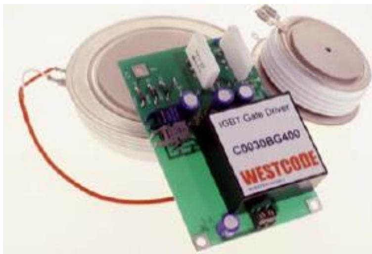
**Slika 4.5.** Suvremeni IGBT s kontrolnom jedinicom[11]
