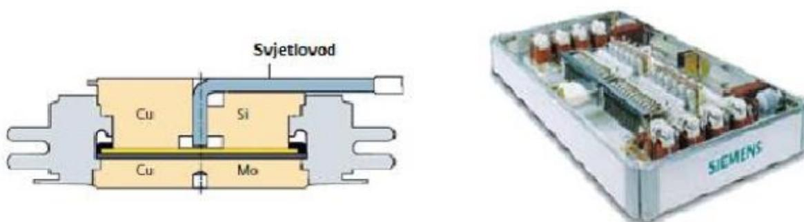
**Slika 3.5.** Presjek LTT tiristora i LTT tiristorski modul[3]
