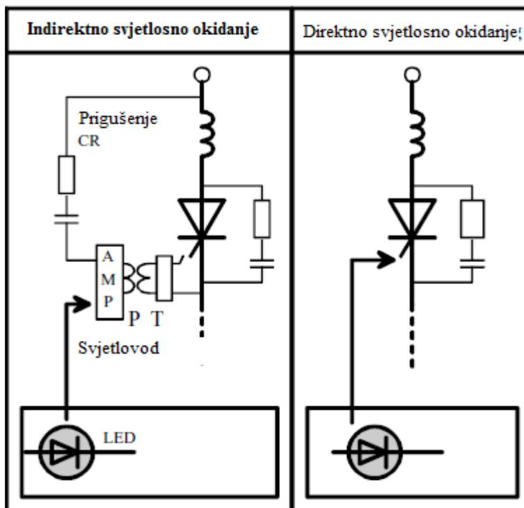
**Slika 3.6.** Indirektno (lijevo) i direktno svjetlosno okidanje (desno) [1]
