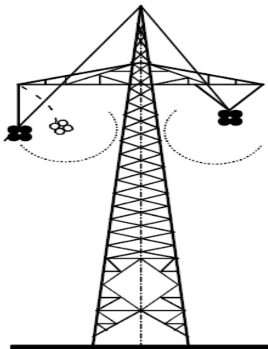
**Slika 3.13.** Konfiguracija stupa za dvopolni istosmjerni visokonaponski prijenos[1]
