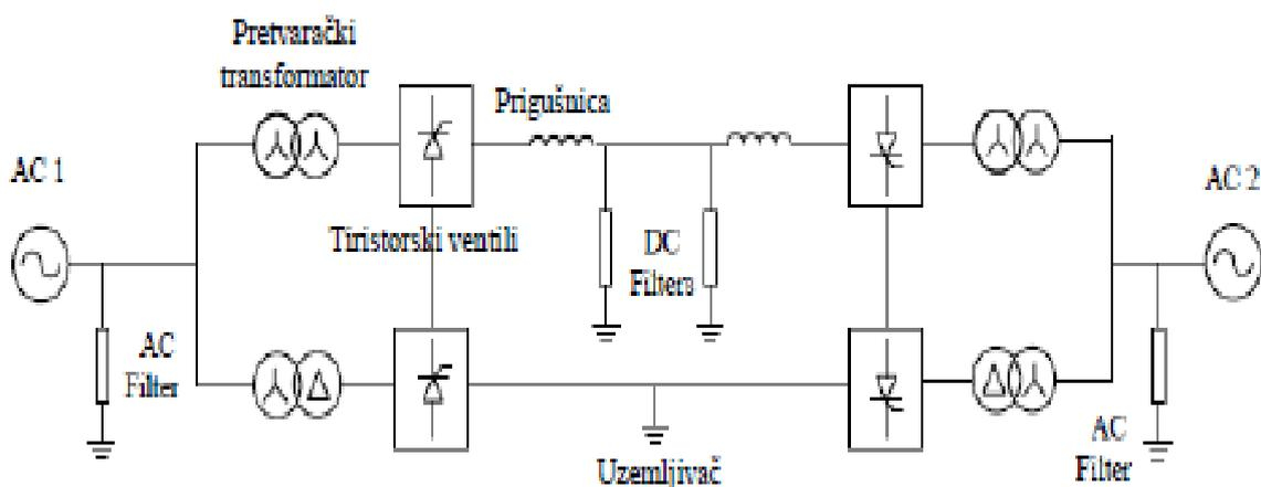
Slika 3.16. Back-to-back konfiguracija povezivanja istosmjernog sustava prijenosa[5]
