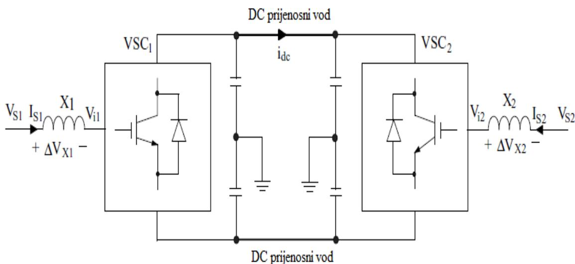
**Slika 4.6.** Shema HVDC sustava s VSC pretvaračima[1]
