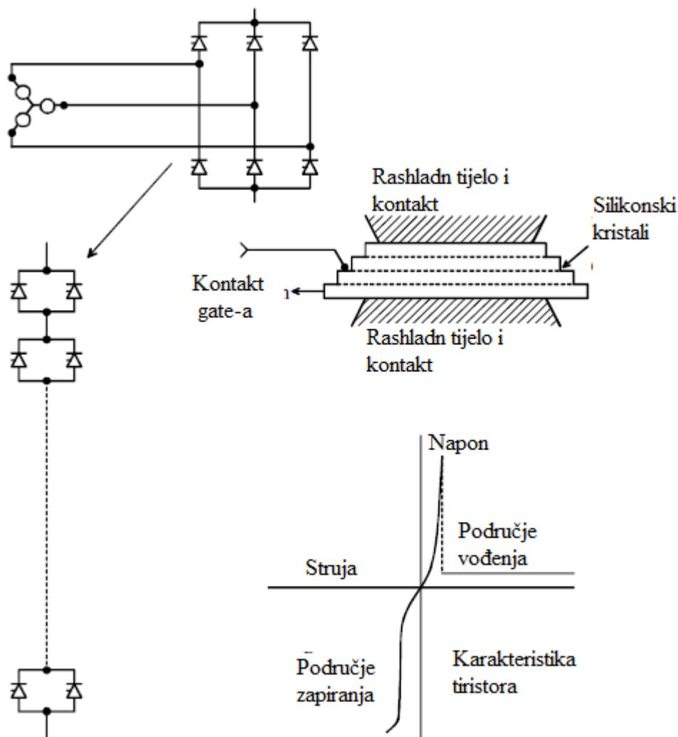
Slika 3.4. Sklop tiristora(tiristorskog ventila) i simbol [1]
