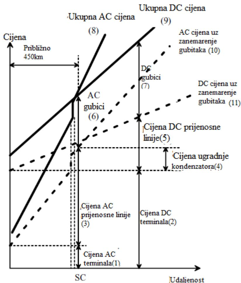
**Slika 2.3.** Prikaz gubitaka izmjeničnog(AC) i istosmjernog (DC) prijenosa u ovisnosti o udaljenosti prijenosa.[1]
