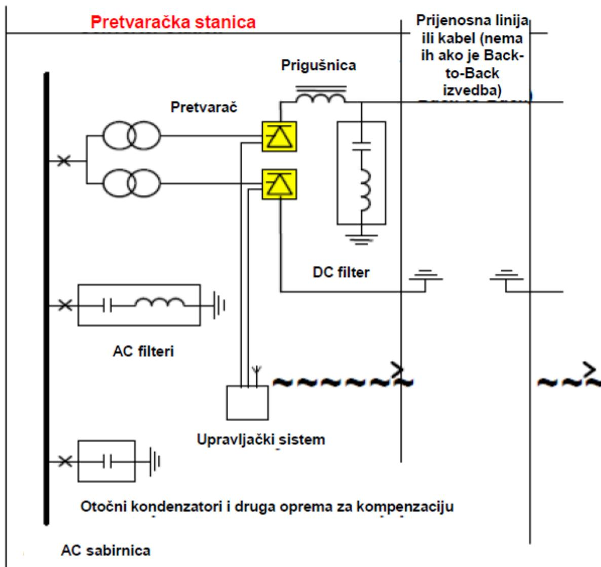
Slika 3.2. Blokovski prikaz pretvaračke stanice istosmjernog prijenosnog sustava[5]
