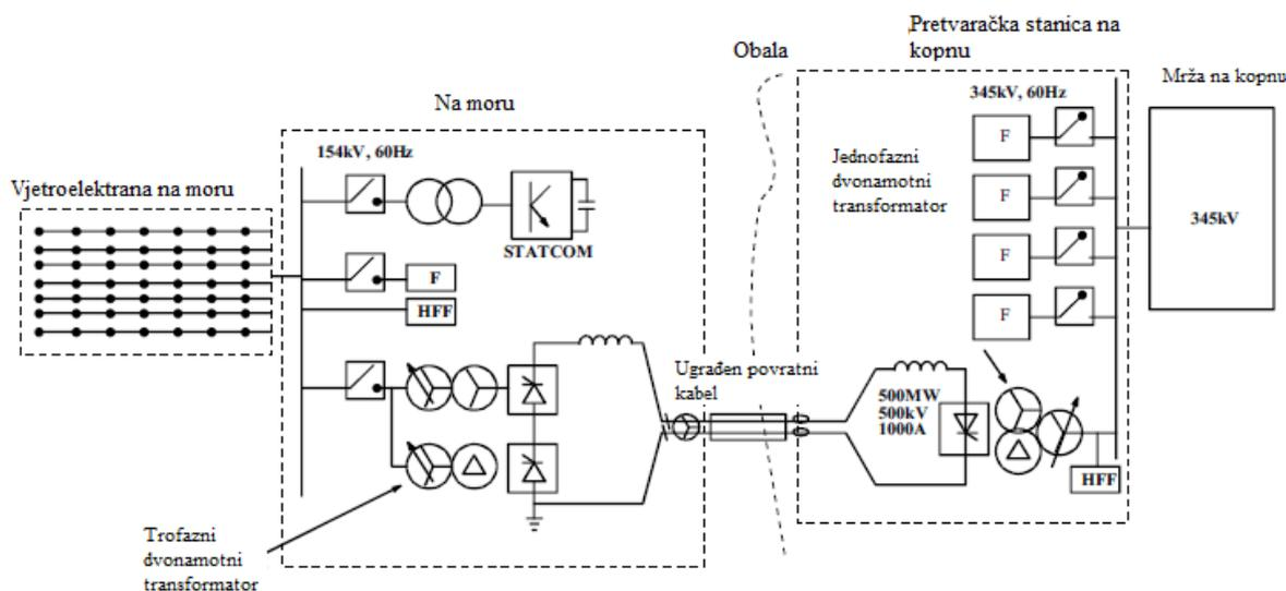
Slika 5.2. Jednopolna shema vjetroelektrane s HVDC sustavom[1]
