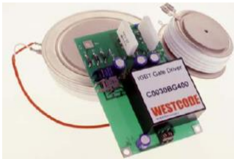
Slika 4.5. Suvremeni IGBT s kontrolnom jedinicom[11]
