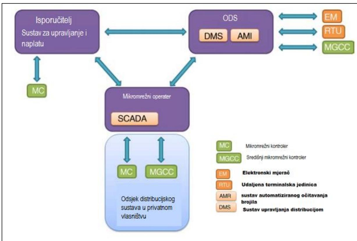
S1. 3.3. Konfiguracija mikromrežnog operatora
