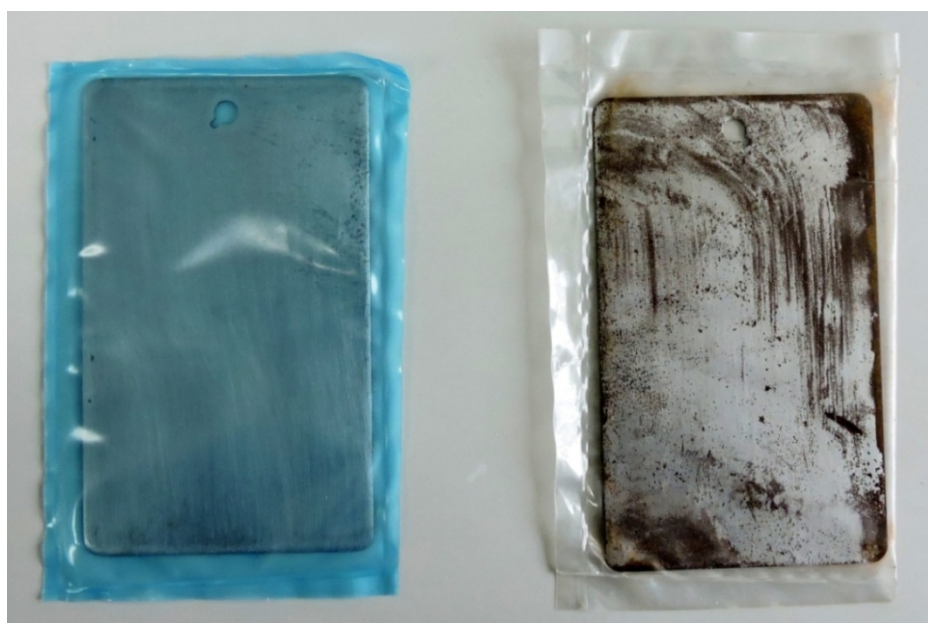
Slika 3.5.1.1. Primjer zaštićenog i nezaštićenog uzorka, [28].
