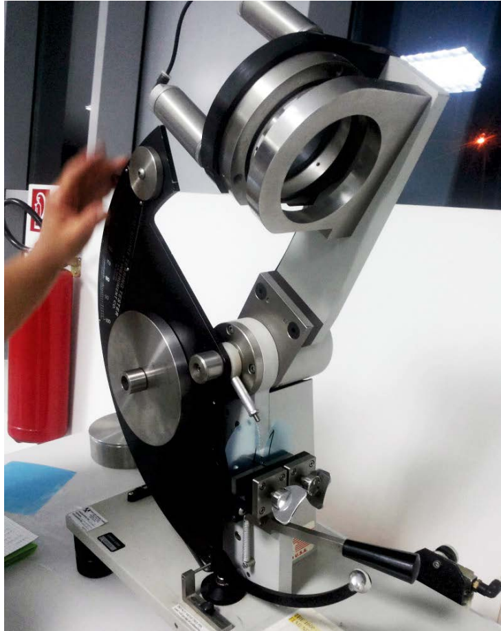
Slika 3.5.2.2. Test cijepanja VpCI – 126 folije, [29].
