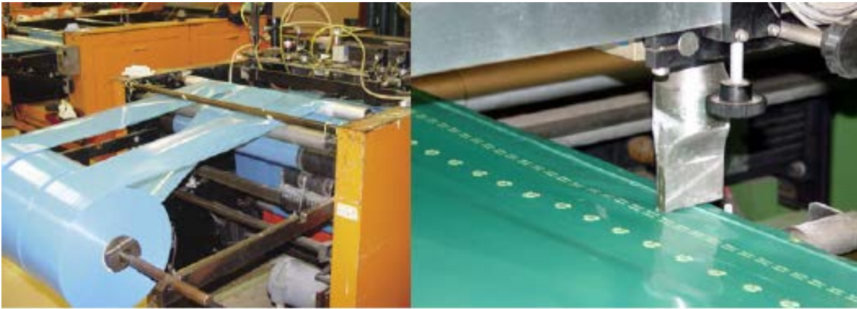
Slika 3.1.2. Oblikovanje (lijevo) i tiskanje (desno) na folijama prilikom proizvodnje, [12].
