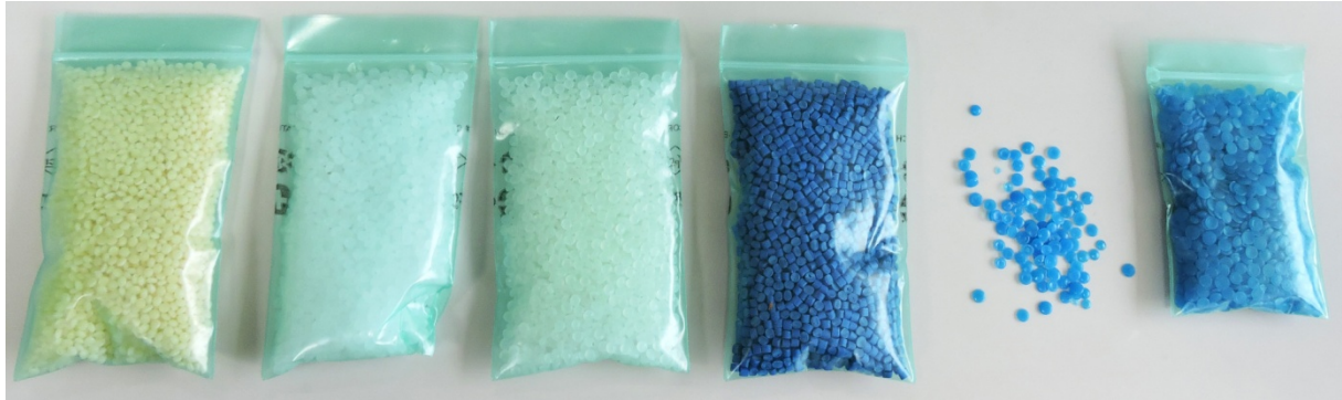
Slika 3.2.2. Granulat od polietilena za proizvodnju folija, [28].
