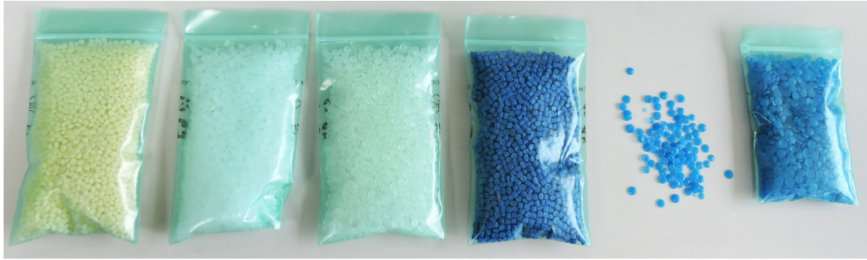
Slika 3.2.2. Granulat od polietilena za proizvodnju folija, [28].
