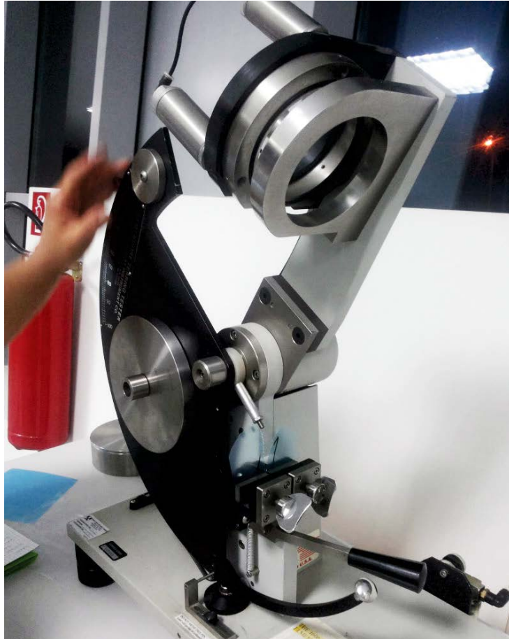
Slika 3.5.2.2. Test cijepanja VpCI – 126 folije, [29].
