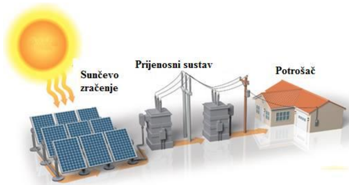
Slika 3.9. Priključak fotonaponske elektrane preko transformatorske stanice [23]
