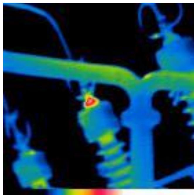
Slika 4.4.11. Izravno ispitivanje – očitanje temperature [5]
