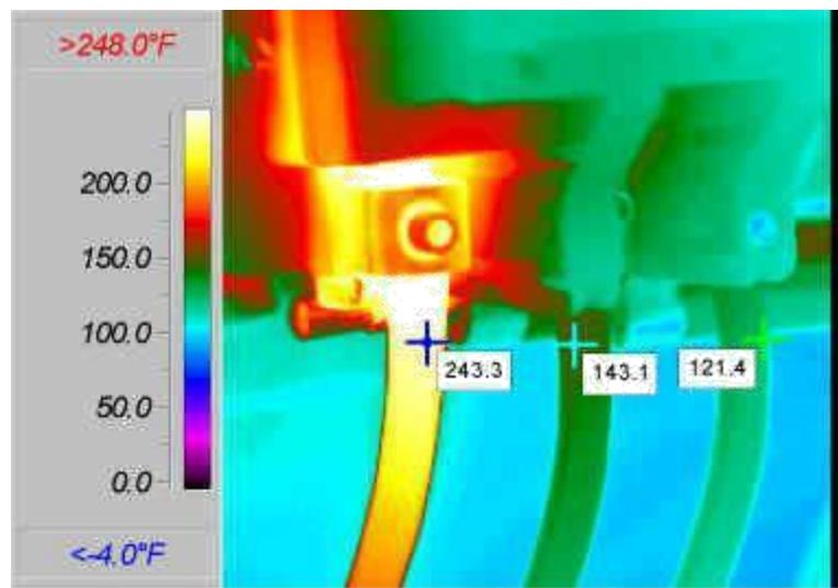
Slika 4.4.10. Kvar na spoju otkriven termovizijском kamerom [5]
