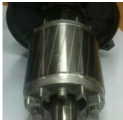
Slika 4.2.2. Fotografija rotorskog paketa i kaveza s perima za balans [1]
