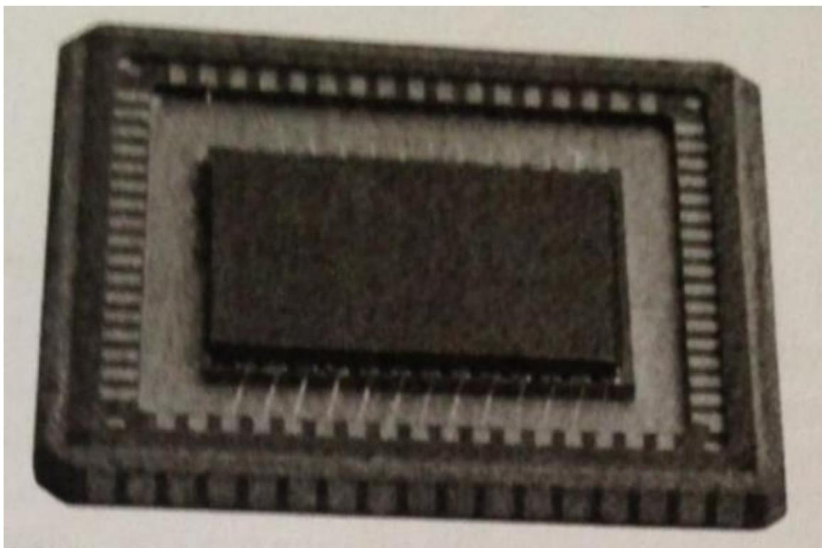
Slika 2.6.4. CCD čip s 480\*640 senzorskih elemenata [7]
