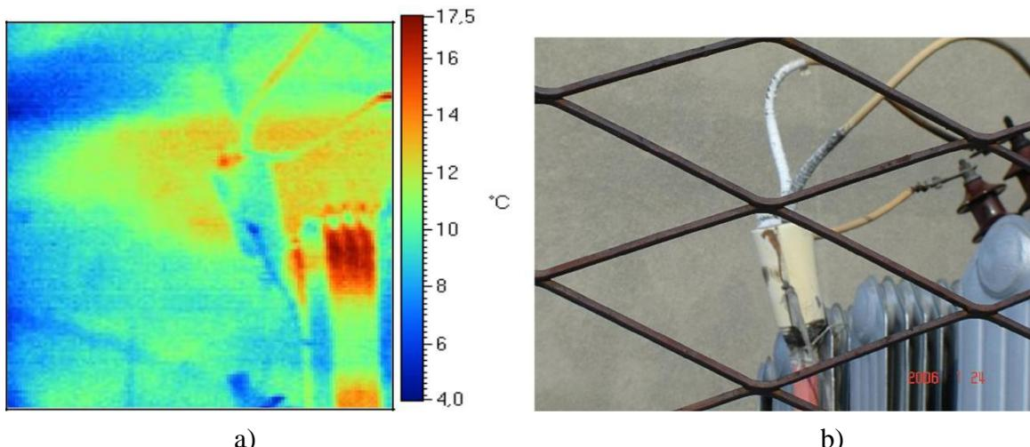
Slika 4.5.1. Termovizijski a) i vidljivi b) fotografija kablove glave TS 35/10 kV [12]
