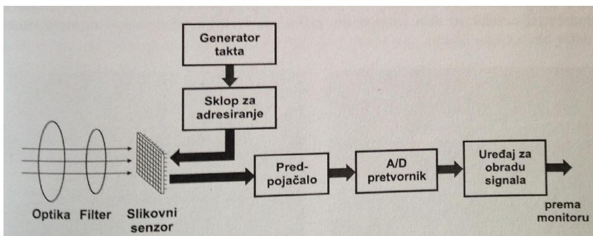
Slika 2.6.5. Blokovski prikaz termografske kamere sa slikovnim senzorom [7]
