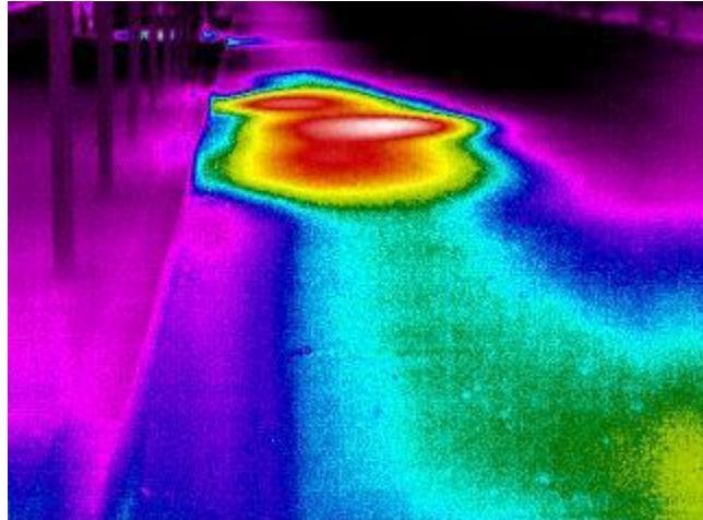
Slika 4.4.1. Propust magistralnog podzemnog Vrelovoda [4]
