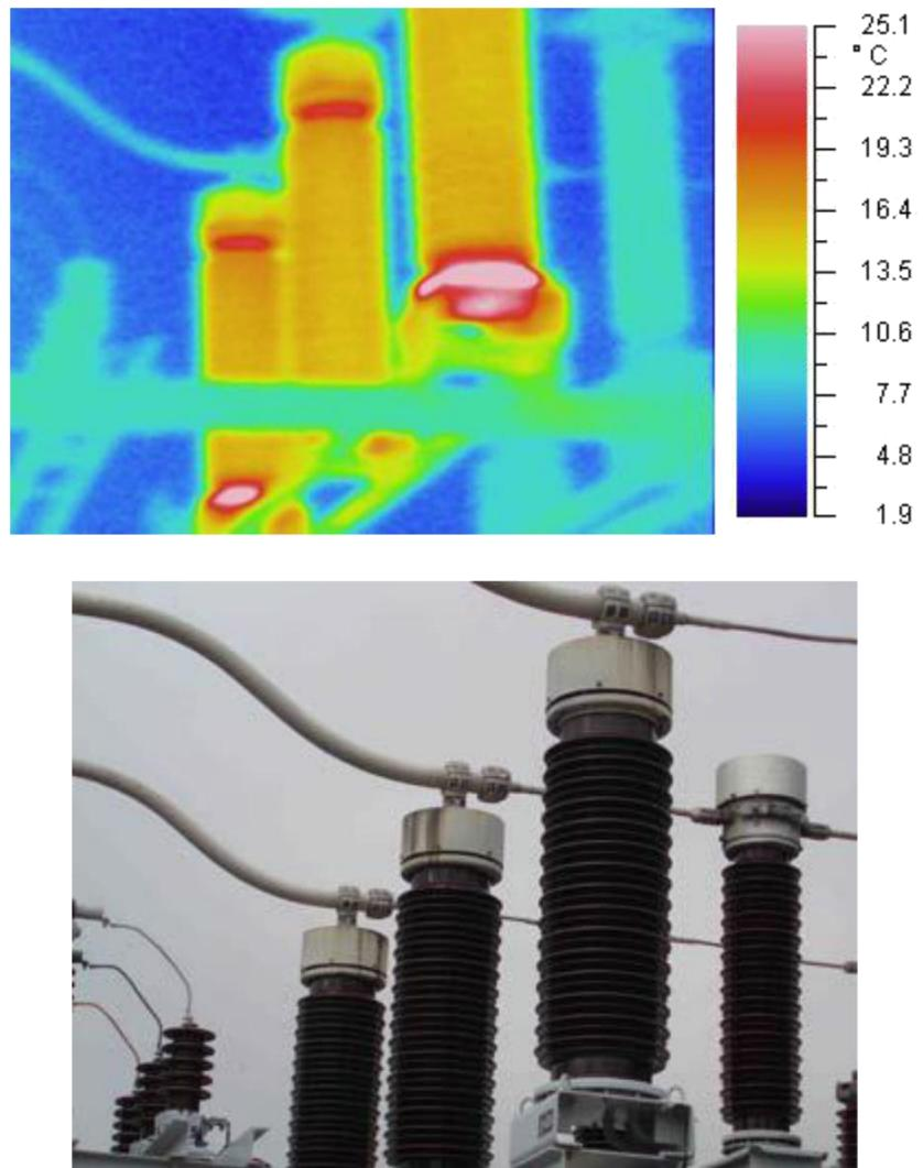
Slika 4.4.5. Termogram naponskih mjernih transformatora u transformatorskom polju [5]
