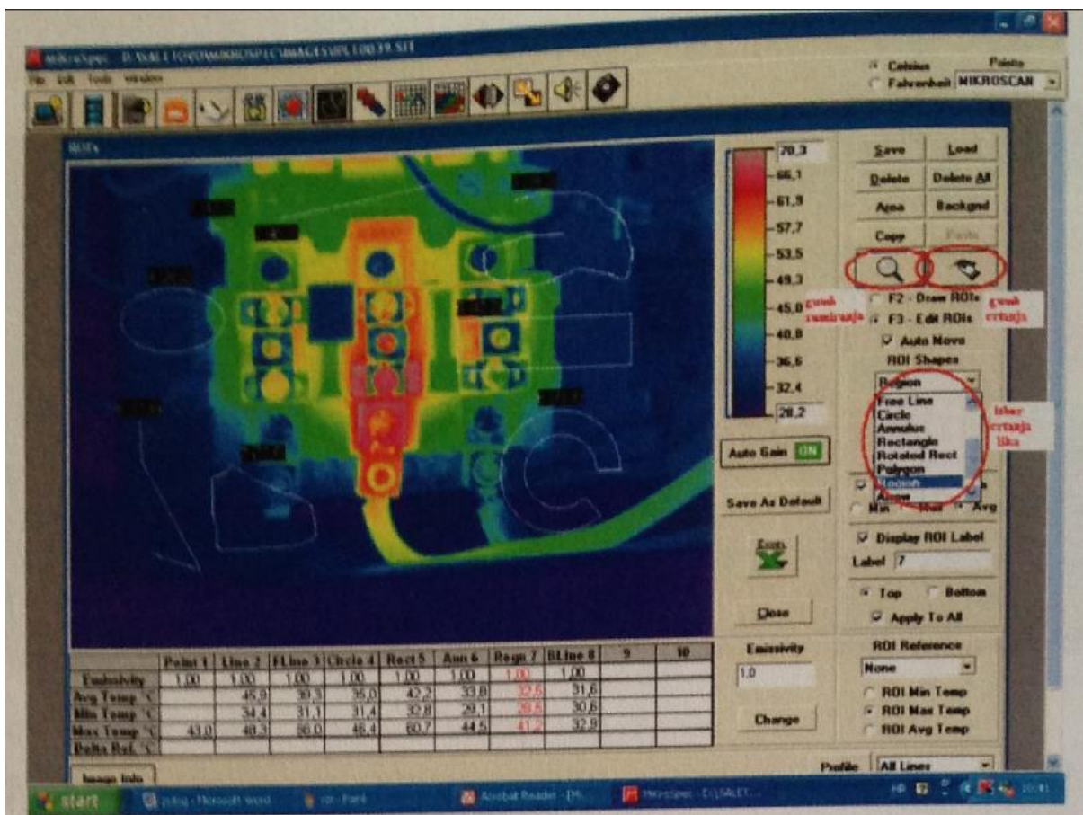
Slika 3.2.1. Izbor područja za detaljniju analizu termograma [7]
