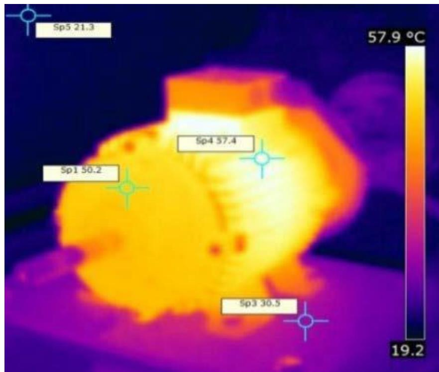
Slika 4.2.1. Termo slika motora u pogonu [1]
