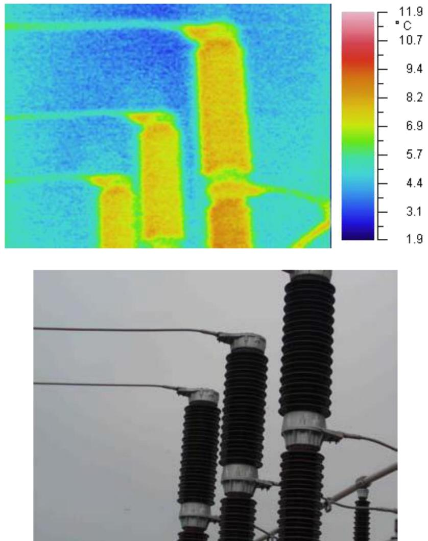
Slika 4.4.8. Termogram visokonaponskih prekidača u trafo polju 1 [5]
