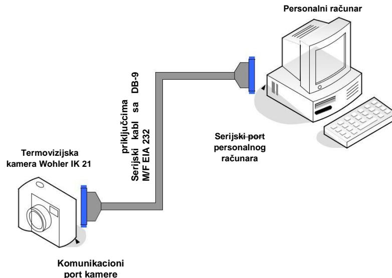
Slika 3.1.1. Shema računalno upravljene termovizijske kamere [12]
