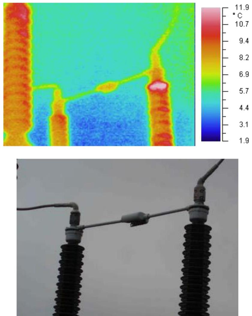
Slika 4.4.9. Termogram visokonaponskog rastavljača u transformatorskom polju [5]
