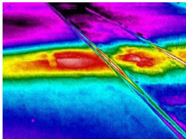
Slika 4.4.3. Propust instalacije ispod tramvajskih Tračnica [4]
