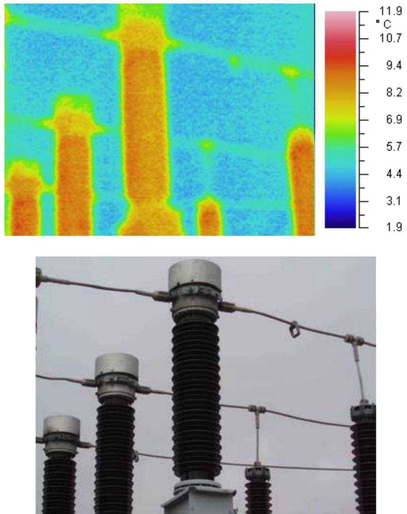
Slika 4.4.6. Termogram strujnih mjernih transformatora u trafo polju 1 [5]
