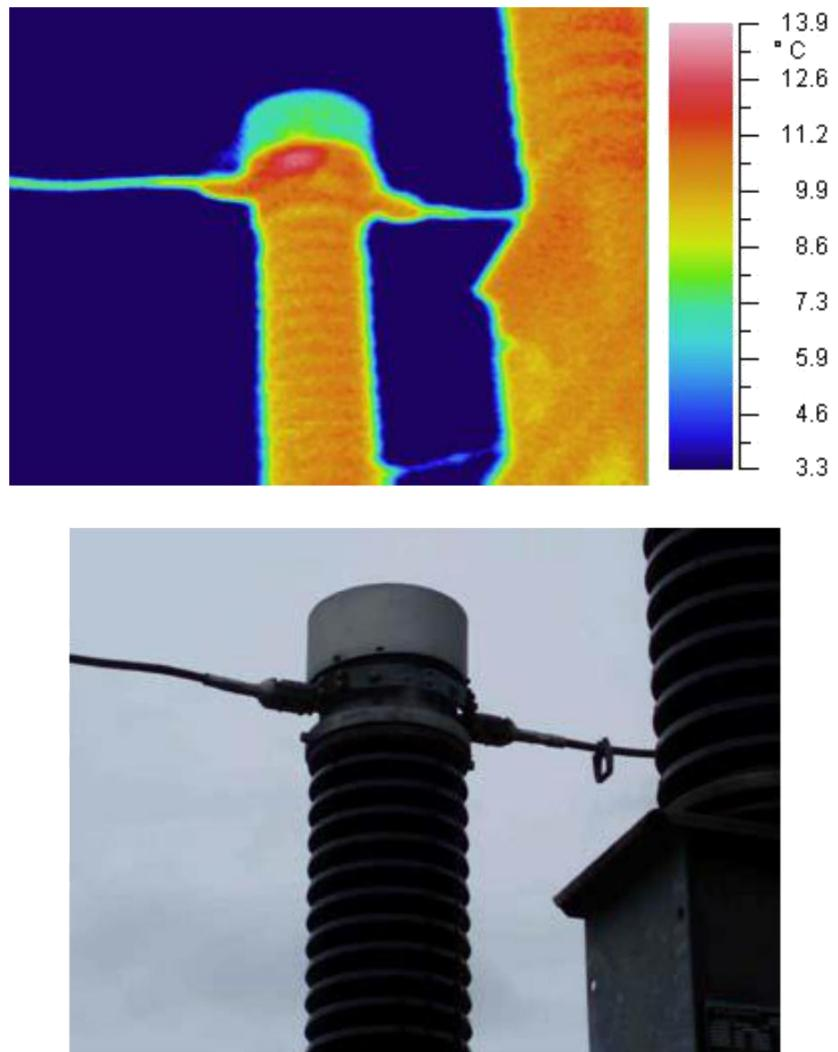
Slika 4.4.7. Termogram strujnog mjernog transformatora u vodnom polju [5]
