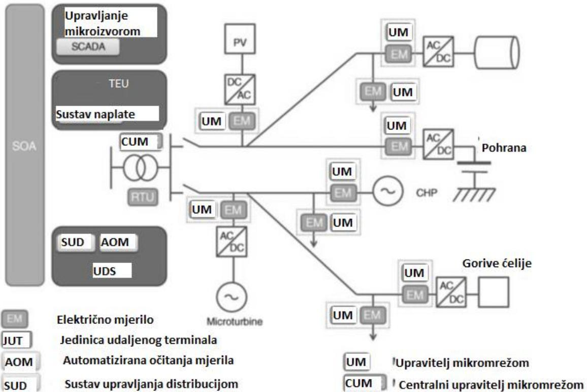
**Slika 3.2.** Prikaz distribucijskog sustava s upravljačkim komponentama
