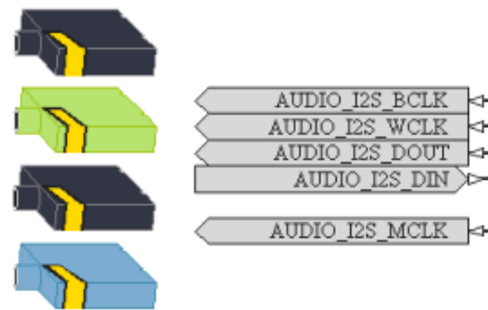
Slika 3.5: AUDIO_CODEC komponenta iz „FPGA NB3000 Port-Plugin.IntLib“ biblioteke
