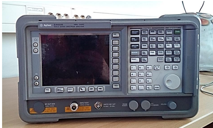
Slika 3.7. Spektralni analizator Agilent ESA-E E4402B
