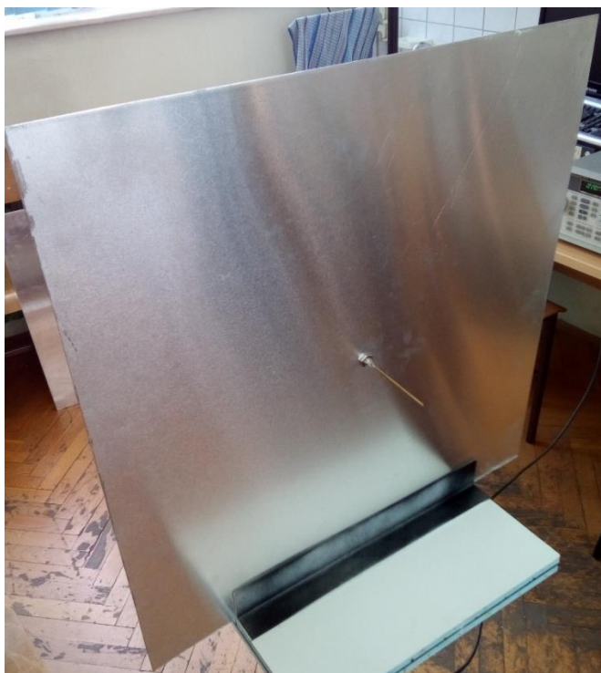
Slika 3.2. Laboratorijski model unipol antene za centralnu frekvenciju 900 MHz
