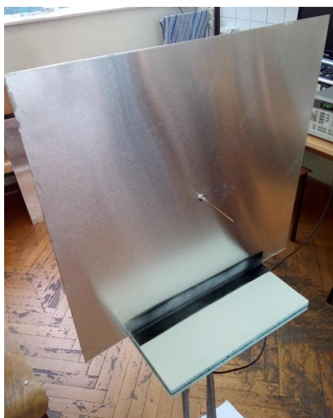
Slika 3.21. Odašiljačka unipol antena za 900 MHz na stalku prilikom mjerenja dijagrama zračenja u E ravnini
