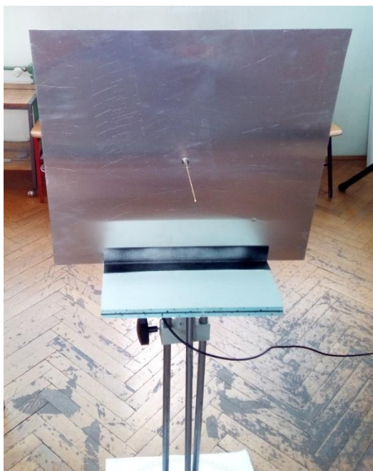
Slika 3.13. Unipol antena za centralnu frekvenciju 500 MHz na stalku prilikom mjerenja dijagrama zračenja u E ravnini
