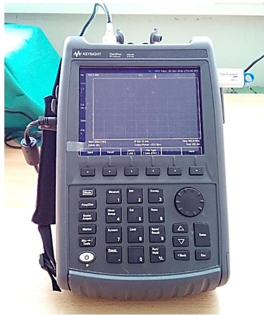
*Slika 3.5. Spektralni analizator AGILENT FieldFox N9912A*
