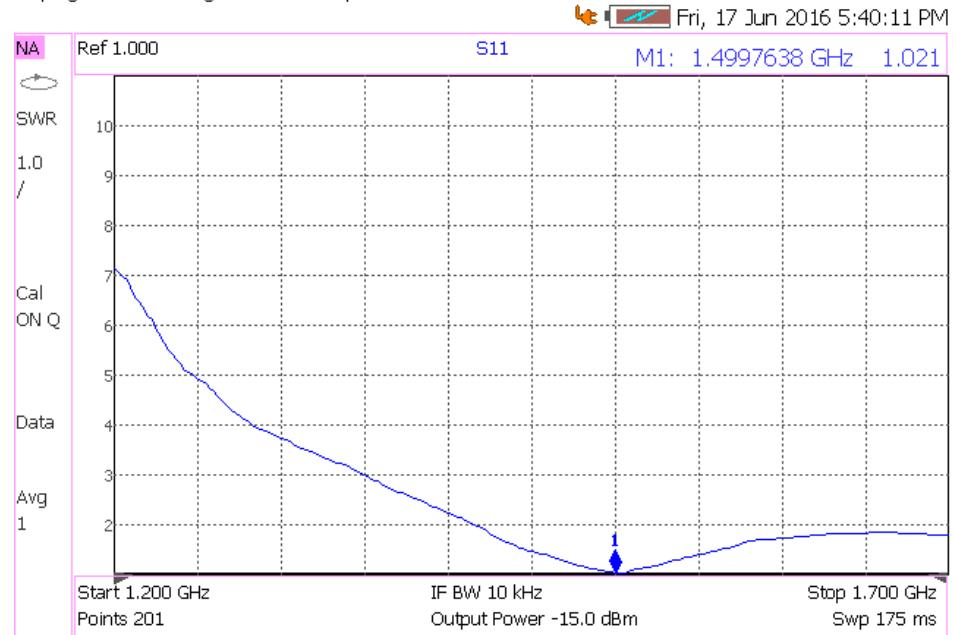
Slika 3.25. Prikaz VSWR parametra unipol antene za centralnu frekvenciju 1500 MHz
