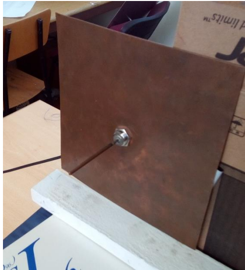
Slika 3.22. Prijemna unipol antena za 900 MHz prilikom mjerenja dijagrama zračenja u E ravnini
