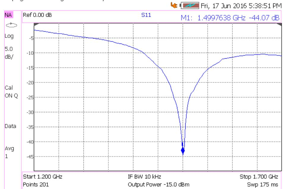
Slika 3.25. Prikaz  $S_{11}$  parametra unipol antene za centralnu frekvenciju 1500 MHz
