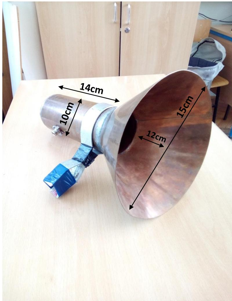
Slika 3.28. Lijevak antena korištena za mjerjenje dijagrama zračenja unipola za 1500 MHz
