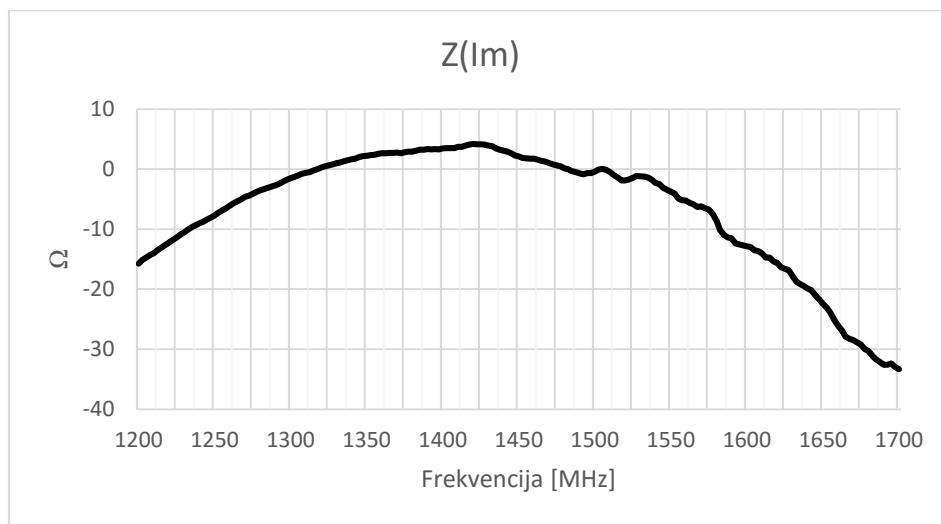
*Slika 3.27. Grafički prikaz ovisnosti imaginarnе komponente ulazne impedancije o frekvenciji za unipol centralne frekvencije 1500 MHz*
