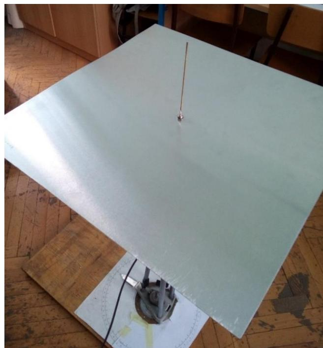
*Slika 3.1. Laboratorijski model unipol antene za centralnu frekvenciju 500 MHz*
