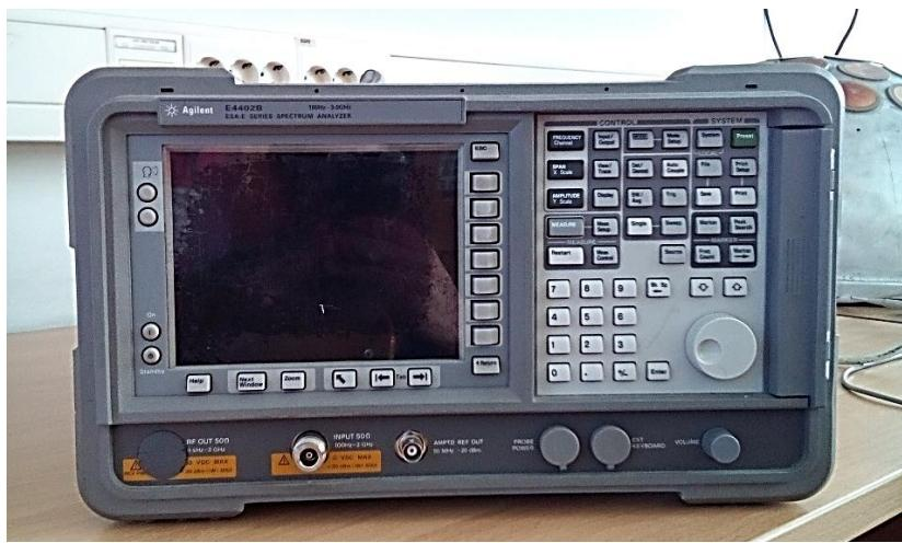
*Slika 3.7. Spektralni analizator Agilent ESA-E E4402B*
