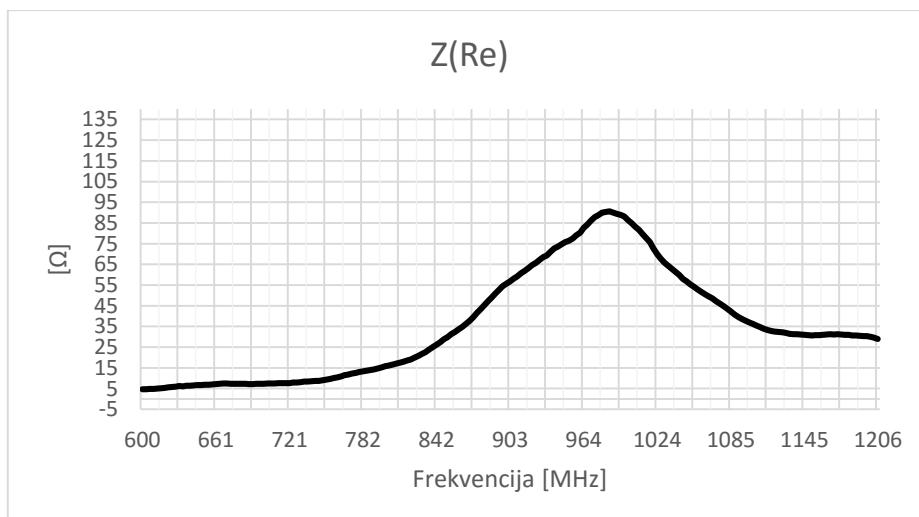
Slika 3.19. Grafički prikaz ovisnosti realne komponente ulagne impedancije o frekvenciji za unipol centralne frekvencije 900 MHz
