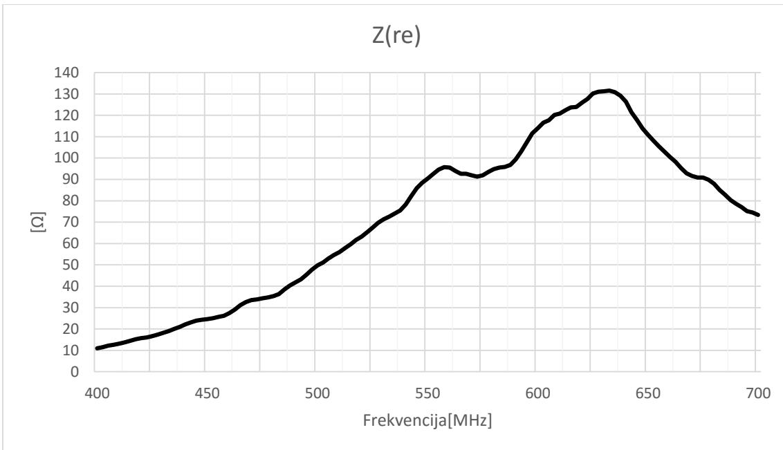
Slika 3.12. Ovisnost realne komponente ulazne impedancije o frekvenciji
