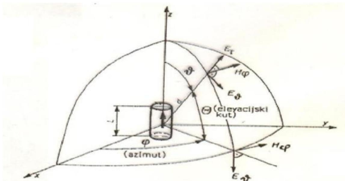
Slika 2.7. Prikaz Hertzovog dipola i komponenti električnog i magnetskog polja na udaljenosti  $d$  od Hertzovog dipola [8]
