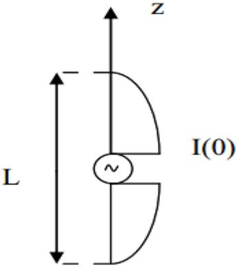
Slika 2.8 Skica sinusne raspodjele struje duljinom dipola
