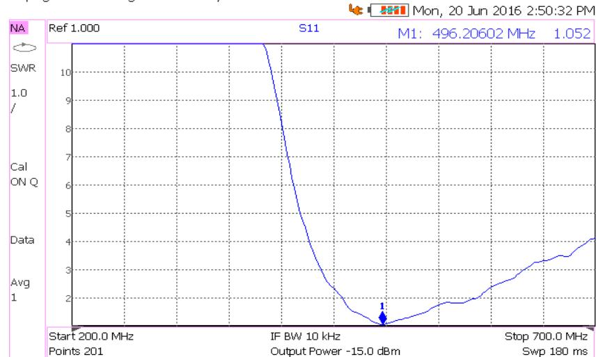
Slika 3.11. Rezultat VSWR mjerena unipol antene za centralnu frekvenciju 500 MHz
