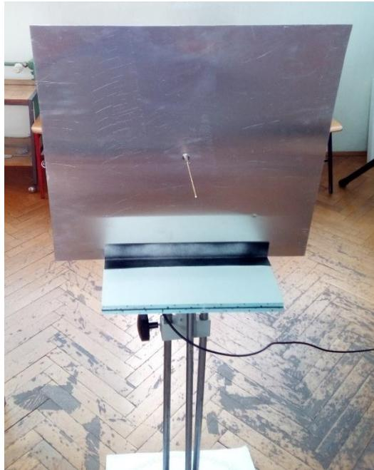
*Slika 3.13. Unipol antena za centralnu frekvenciju 500 MHz na staku prilikom mjerjenja dijagrama zračenja u E ravnini*
