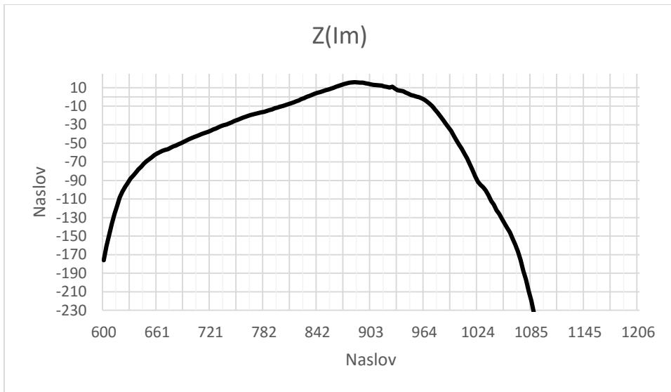
*Slika 3.20. Grafički prikaz ovisnosti imaginarnе komponente ulazne impedancije o frekvenciji za unipol centralne frekvencije 900 MHZ*
