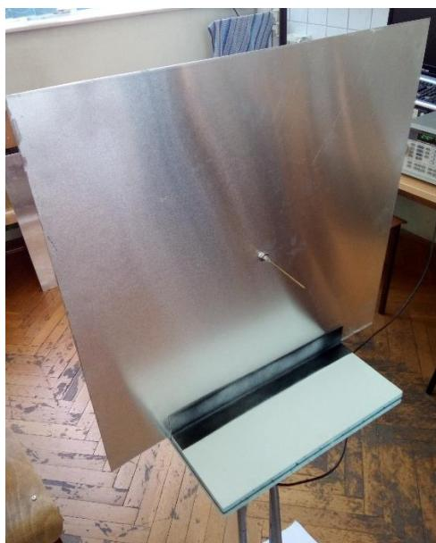
*Slika 3.21. Odašiljačka unipol antena za 900 MHz na stalku prilikom mjerena dijagrama zračenja u E ravnini*
