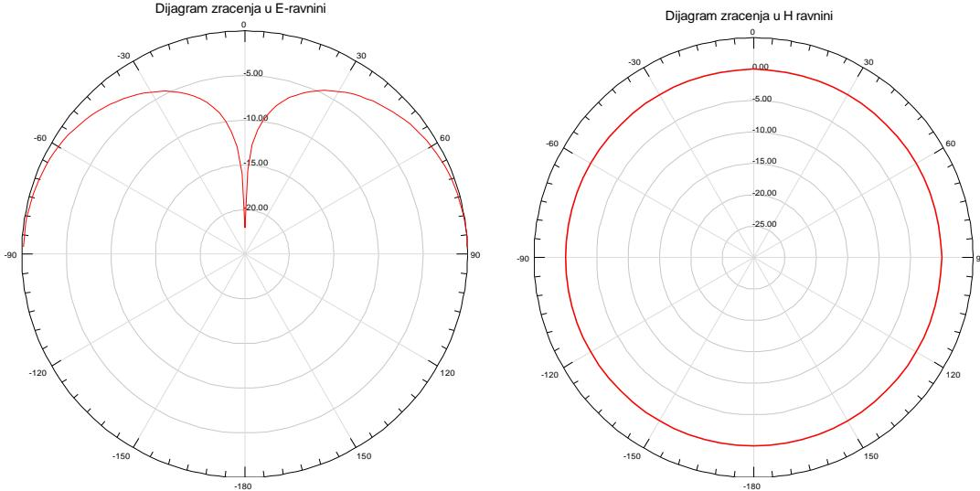
Slika 2.2. Polarni dijagram zračenja u E i H ravnini četvrtvaljnog unipola
