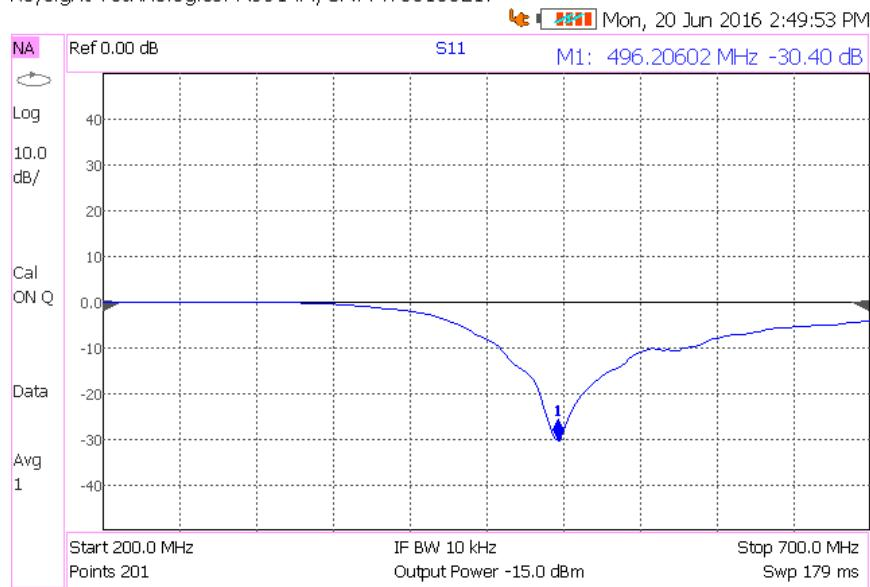
Slika 3.10. Rezultat  $S_{11}$  mjerena unipol antene za centralnu frekvenciju 500 MHz
