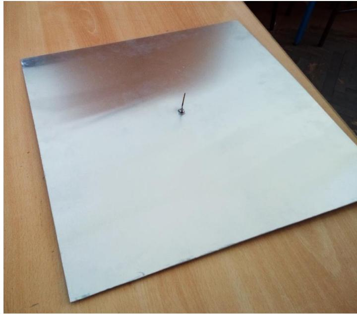
Slika 3.3. Laboratorijski model unipol antene za centralnu frekvenciju 1500 MHz
