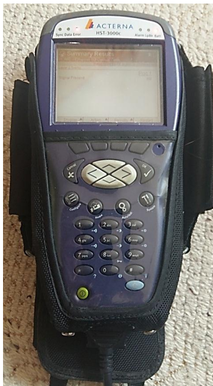
Slika 4.24 Mjerni instrument JDSU Acterna HST3000c
