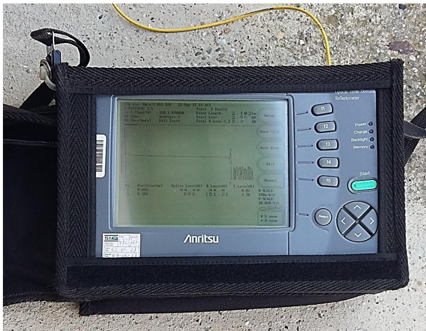
Slika 4.3 Mjerni instrument OTDR Anritsu MW9070B
