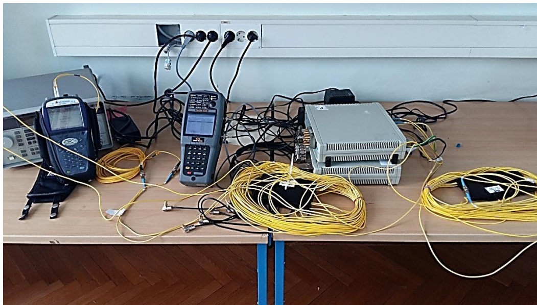
Slika 4.31 Prikaz mjernog okruženja prilikom ispitivanja funkcionalnosti WDM sprežnika
