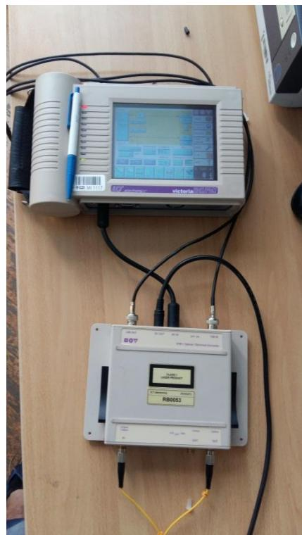
Slika 4.17 Mjerni instrument Victoria 3050c sa spojenim optičkim testnim modulom
