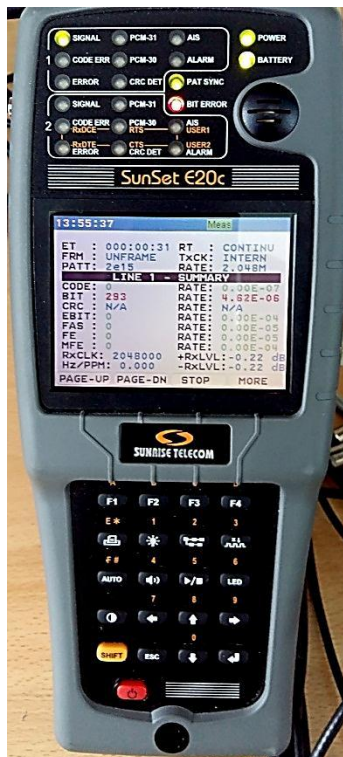
Slika 4.28 Sučelje mjernog instrumenta SunSet E20c pri Low BER alarmu
