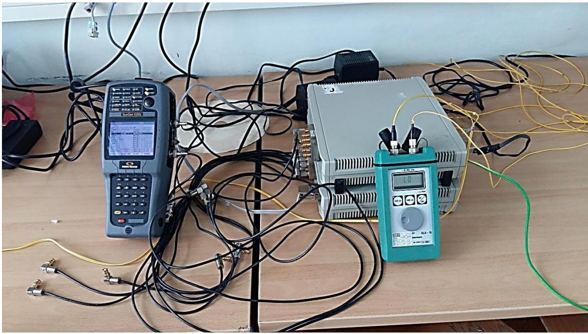
Slika 4.27 Prikaz mjernih instrumenata i uređaja prilikom mjerjenja TDM signala
