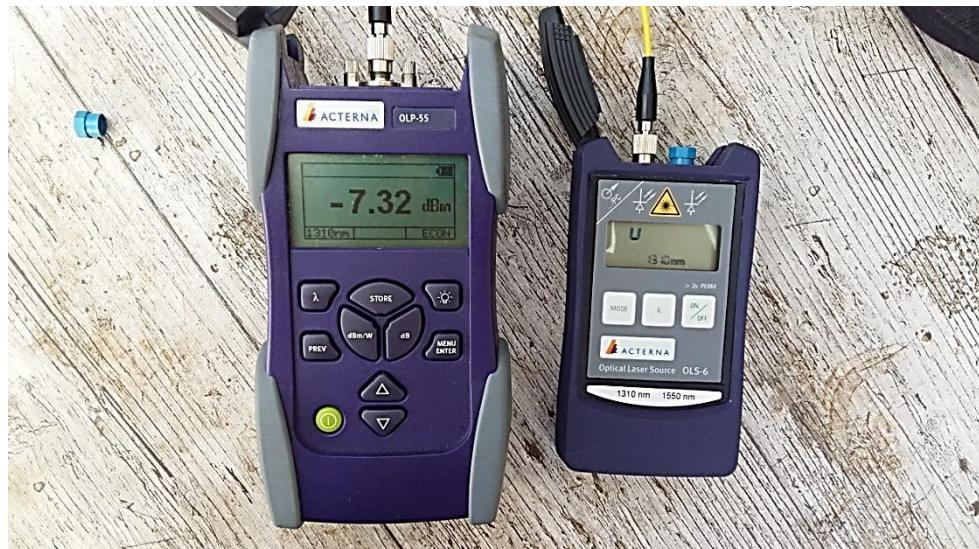
Slika 4.16 Mjerni instrumenti OLP-55 i OLS6
