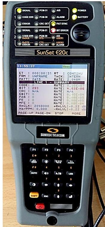
Slika 4.28 Sučelje mjernog instrumenta SunSet E20c pri Low BER alarmu
