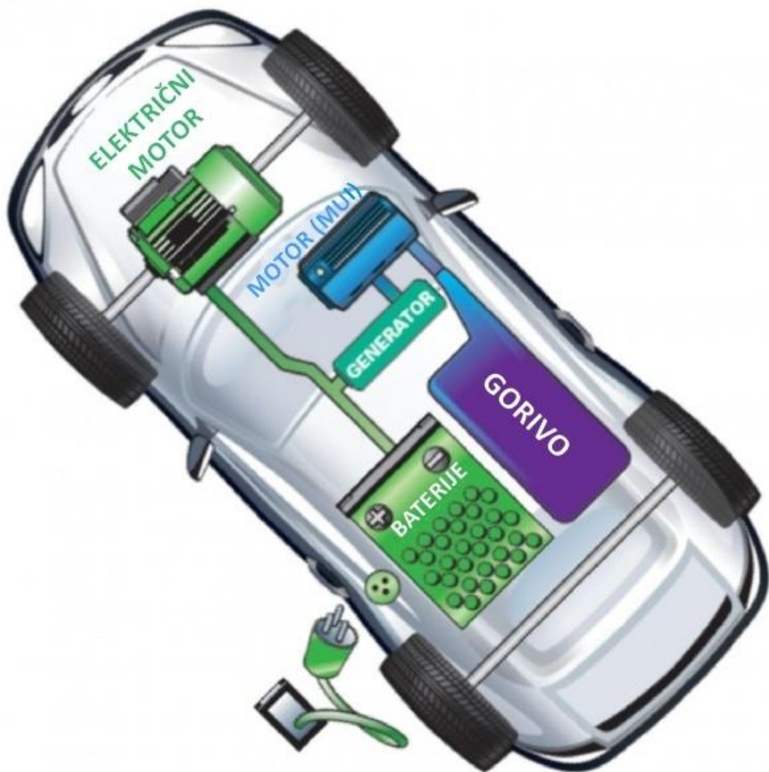
Slika 3.67 Punjivi hibridni automobil sa serijskim hibridnim sustavom
