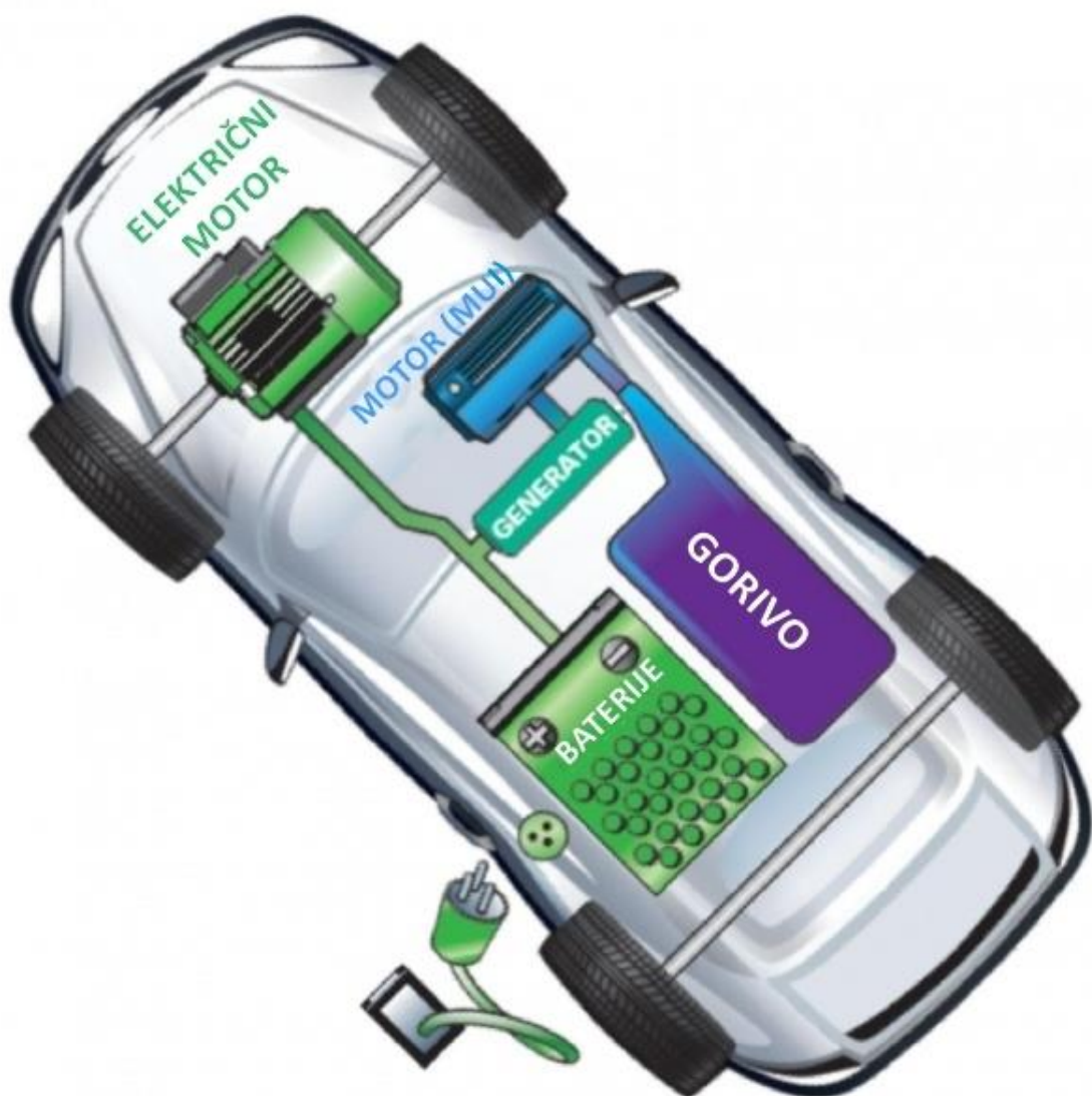
Slika 3.67 Punjivi hibridni automobil sa serijskim hibridnim sustavom
