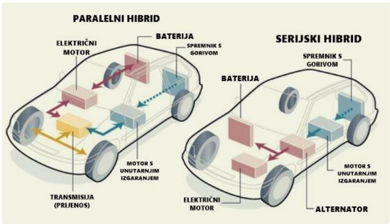
**Slika 3.3.** Usporedba raspodjele komponenata serijske i paralelne izvedbe
