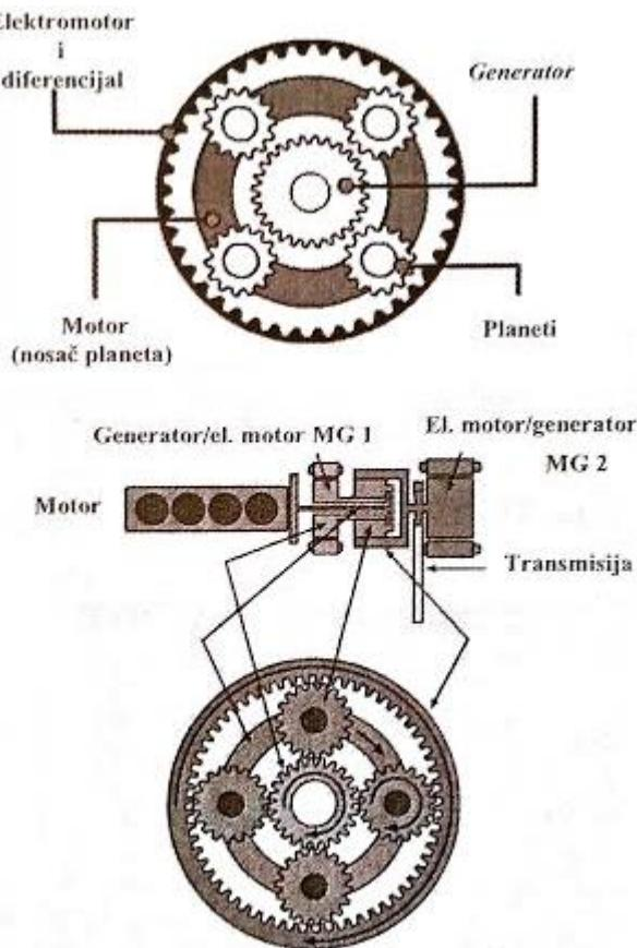
**Slika 2.3. Planetarni sklop zupčanika**
