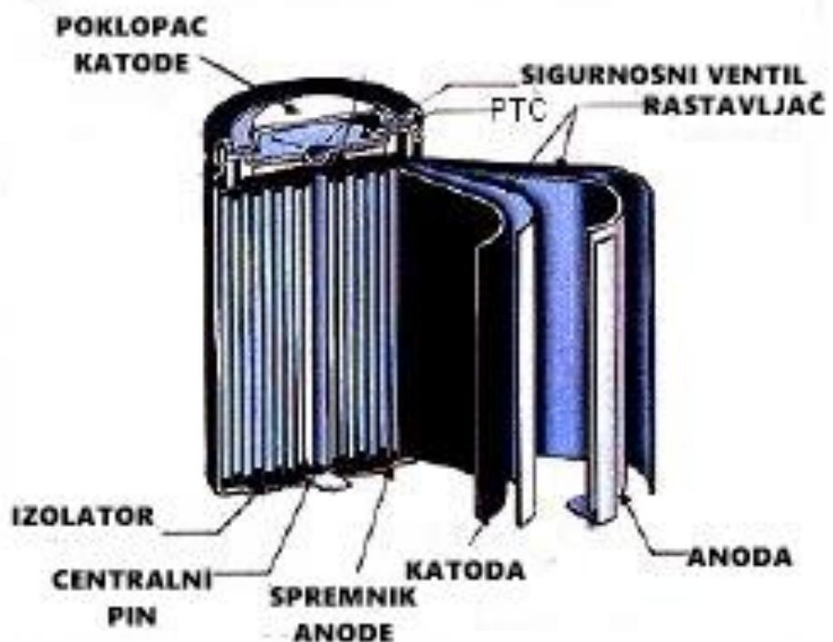
**Slika 2.10.** Presjek Litij-ionske baterije
