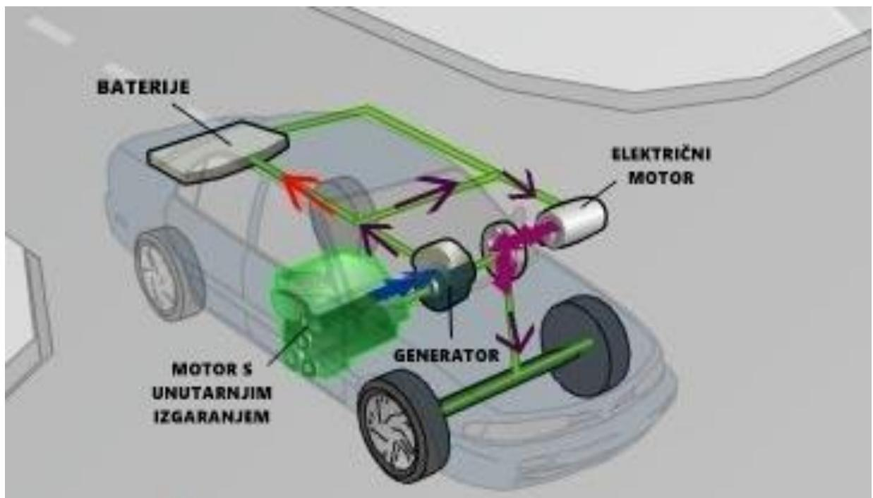
**Slika 4.3.** Vožnja hibridnog automobila pri stalnoj(višoj) brzini
