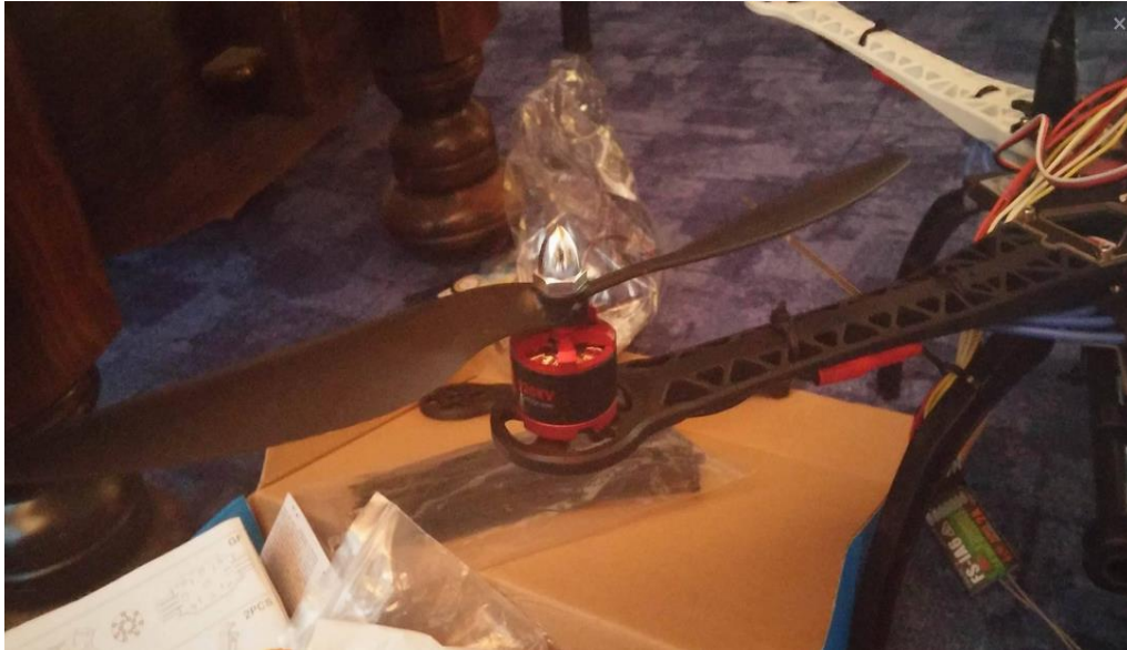
Slika 3.6. Outrunner DC motor sa propelerom
