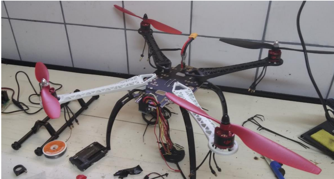
Slika 10.1. Montiranje motora na letjelici
