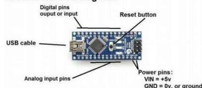
**S1.1.** Mini USB Nano V3.0 CH340G Mikrokontroler za Arduino
