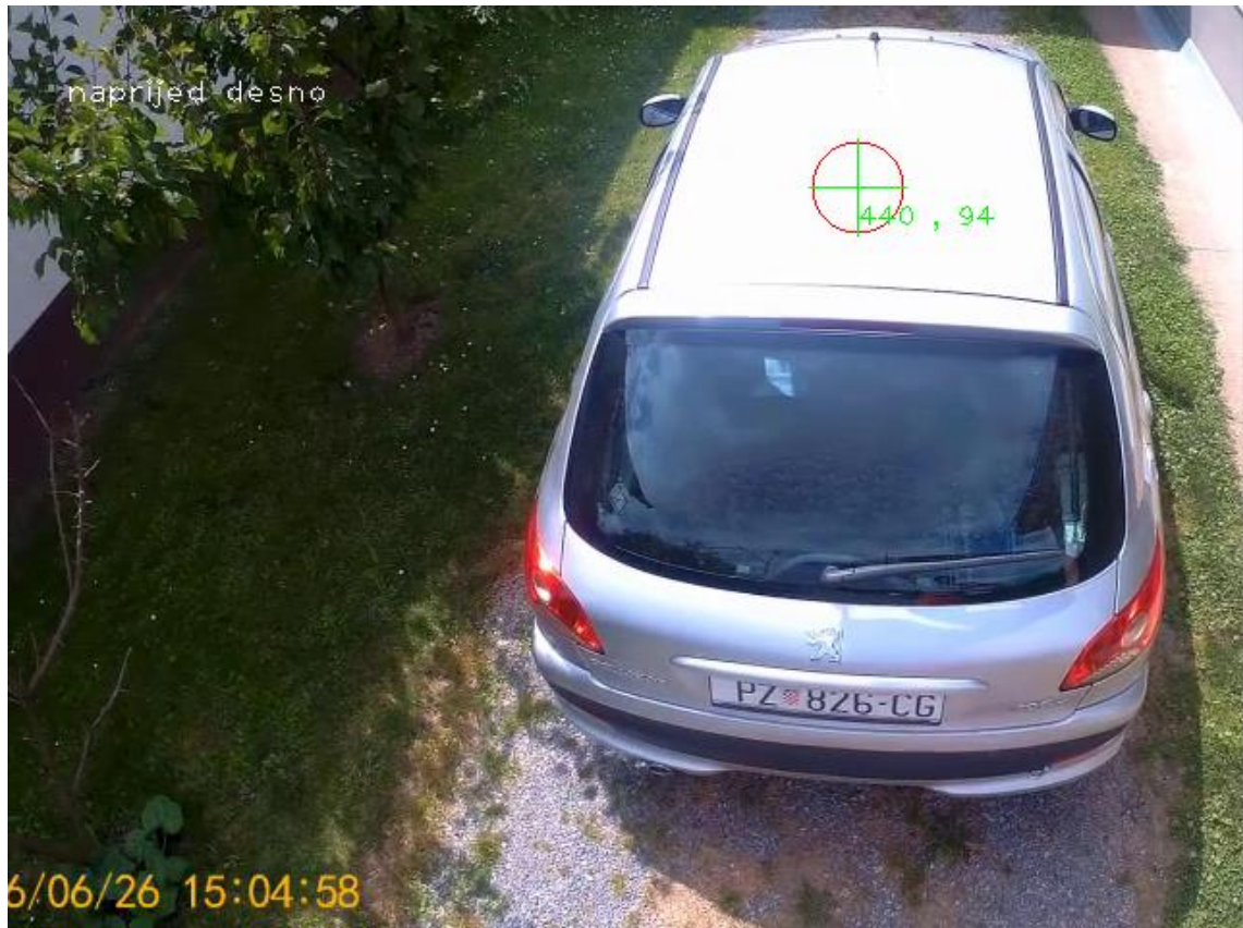
Sl. 3.9. Videozapis u realnom vremenu s prepoznatim središtem automobila
