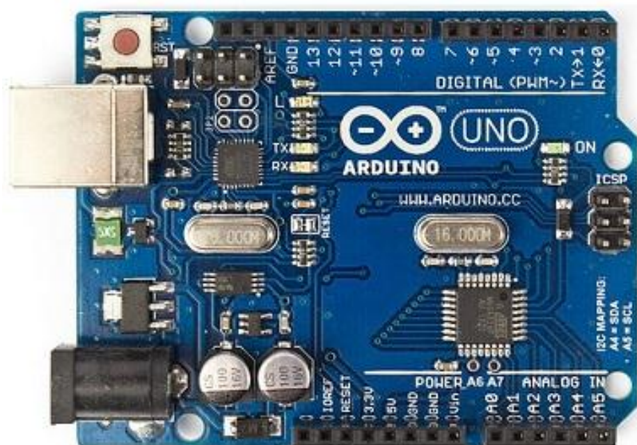
Slika 2.1. Prikaz ArduinoUNO modula
