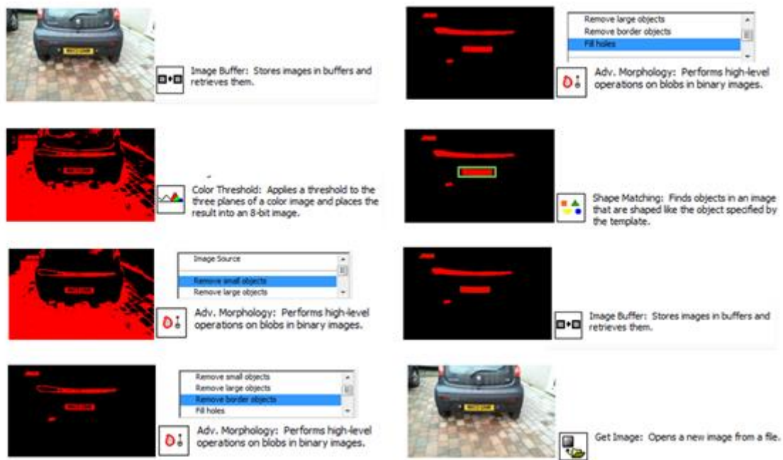
Slika 3.2. Prikaz očitavanja registarskih pločica [10]
