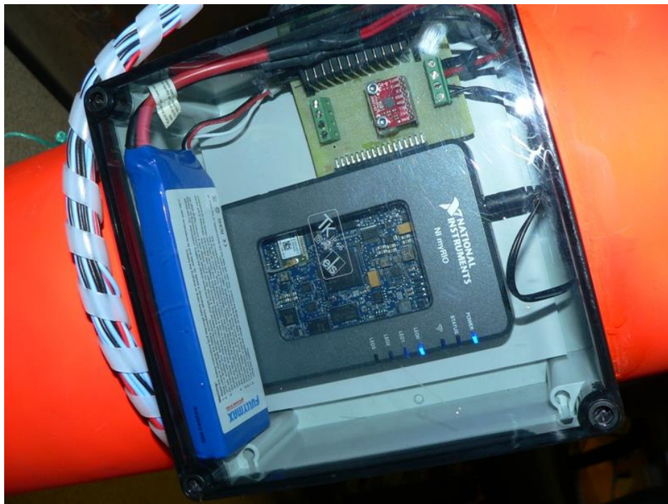
Slika 3.6. Prikaz NI myRIO u unutrašnjosti podmornice [11]
