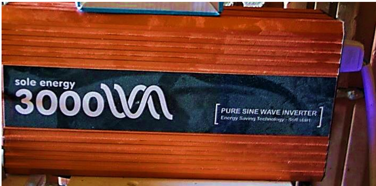
Sl. 3.4. Izmjenjivač koji vrši pretvorbu istosmjernog u izmjenični napon.
