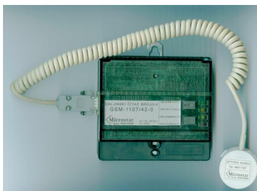
Sl. 6. GSM modem tvrtke Microstar za očitavanje brojila proizvođača RIZ , Iskraemeco i Siemens
