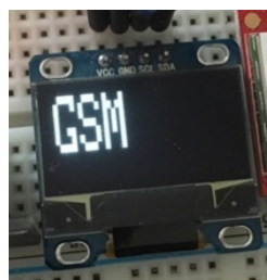
Sl. PD.4. Ispis zaslona kada se odabere način rada 3, odnosno slanje informacija isključivo putem GSM veze.
