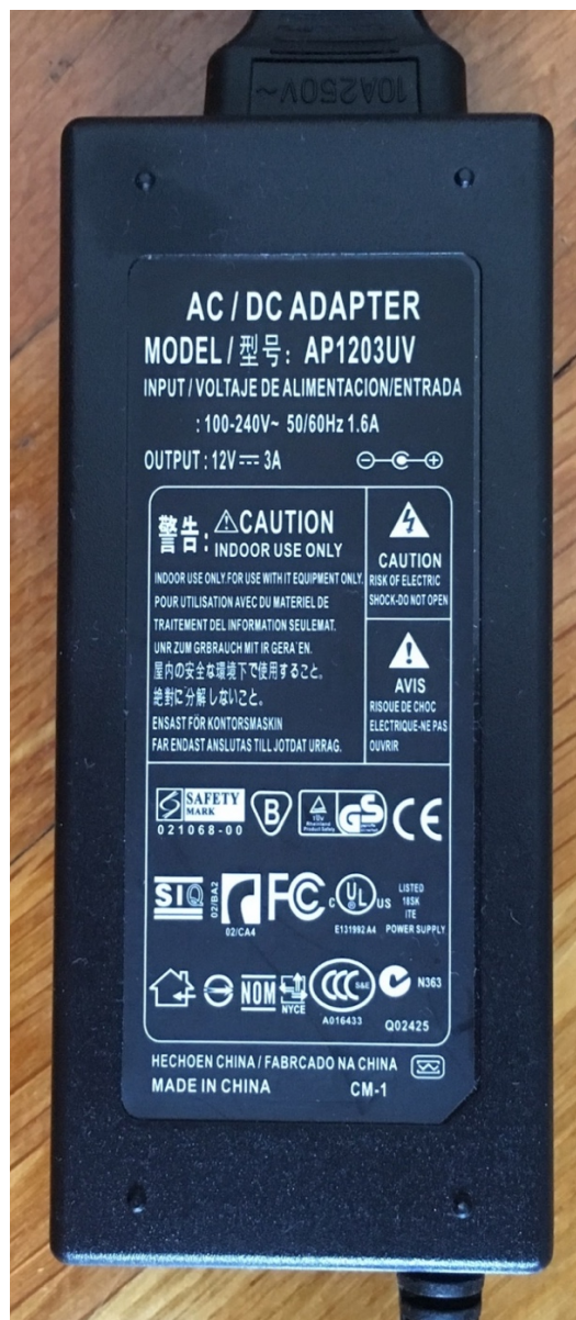
Sl. 2.17. Podnožje vanjskog napajanja AP1203UV.
