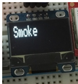
Sl. PD.10. Ispis zaslona pri odabiru plina 5, odnosno očitavanje dima u zraku.
