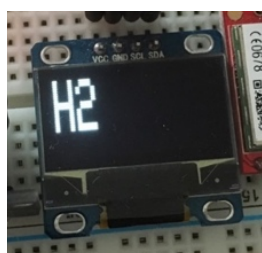
Sl. PD.7. Ispis zaslona pri odabiru tipa plina 2, odnosno očitavanje vodika u zraku.
