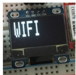
Sl. PD.3. Ispis zaslona kada se odabere način rada 2, odnosno slanje informacija isključivo putem WiFi veze.
