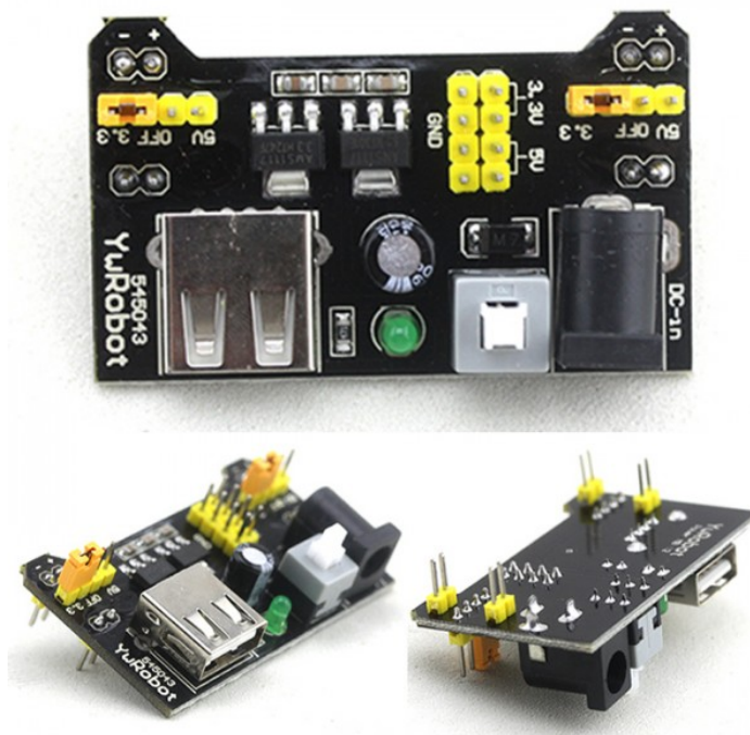
Sl. 2.15. YwRobot 545043 MB102 napajanje eksperimentalne pločice. [26]
