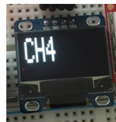
Sl. PD.8. Ispis zaslona pri odabiru tipa plina 3, odnosno očitavanje metana u zraku.
