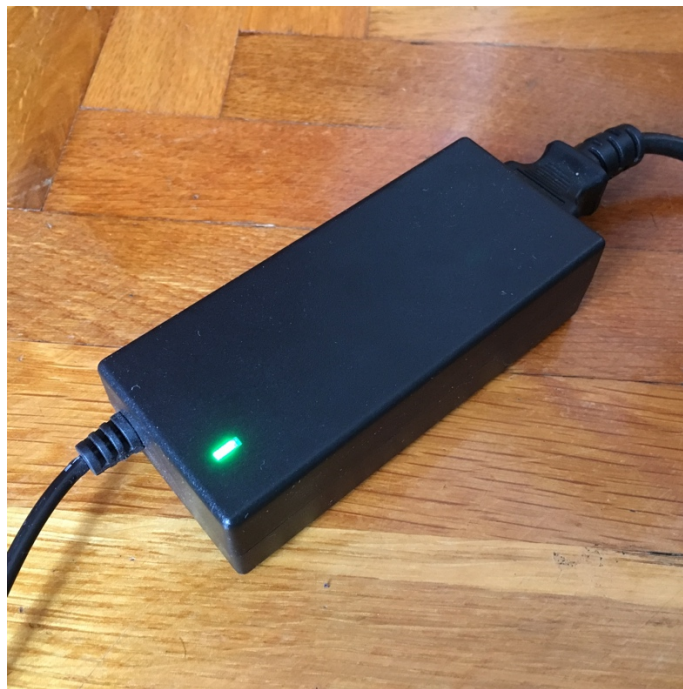
Sl. 2.16. Vanjsko napajanje AP1203UV.
