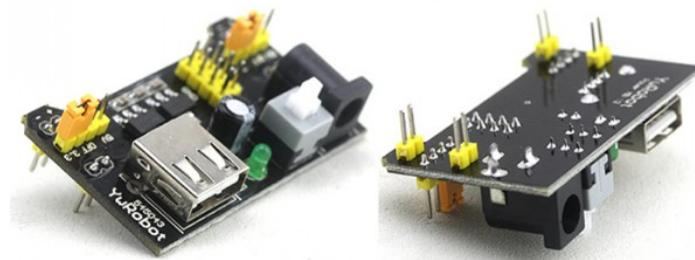
Sl. 2.15. YwRobot 545043 MB102 napajanje eksperimentalne pločice. [26]
