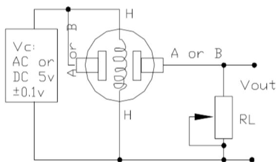
Sl. 2.3. Strujni krug koji opisuje MQ-2 senzor [5]
