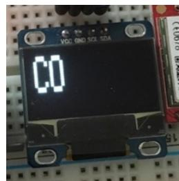
Sl. PD.9. Ispis zaslona pri odabiru tipa plina 4, odnosno očitanje ugljikovog monoksida u zraku.
