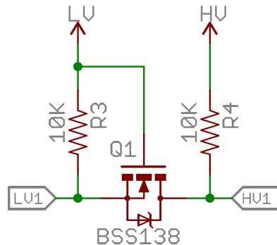
*Sl. 2.9. Električna shema pretvornika logičkih razina [13]*
