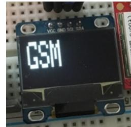
Sl. PD.4. Ispis zaslona kada se odabere način rada 3, odnosno slanje informacija isključivo putem GSM veze.
