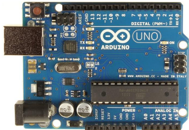
Sl. 2.6. – Arduino UNO platforma sa ATmega328P mikrokontrolerom.
