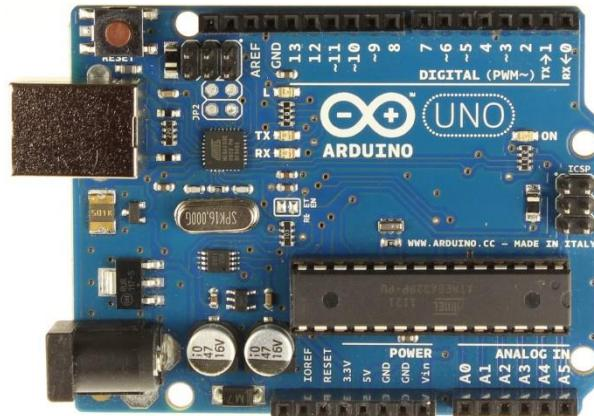
**Sl. 2.6. – Arduino UNO platforma sa ATmega328P mikrokontrolerom.**
