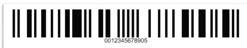
Slika 2.6. EAN-13 barkod niza 001234567890, s izračunatim zaštitnim znakom 5.
