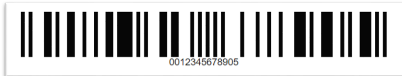
Slika 2.6. EAN-13 barkod niza 001234567890, s izračunatim zaštitnim znakom 5.
